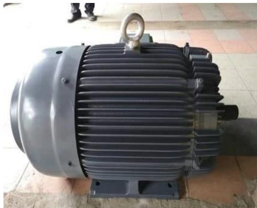
Gambar 3. 9 Motor induksi 3 phasa (Sumber : Dokumentasi 2022)
