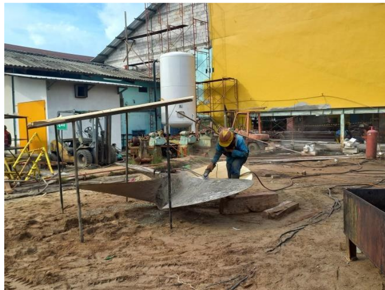
Gambar 2.70 Proses pembersihan propeller kapal MT.Kurau Sumber : Dokumentasi penulis
