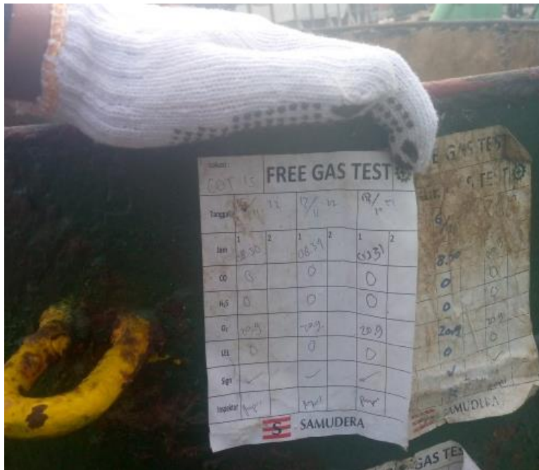
Gambar 2.77 Proses Free Gas Test kapal kurau Sumber : Dokumentasi penulis
