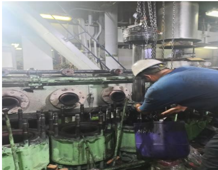
Gambar 2.48 Proses pelepasan piston main engine kapal Kurau
