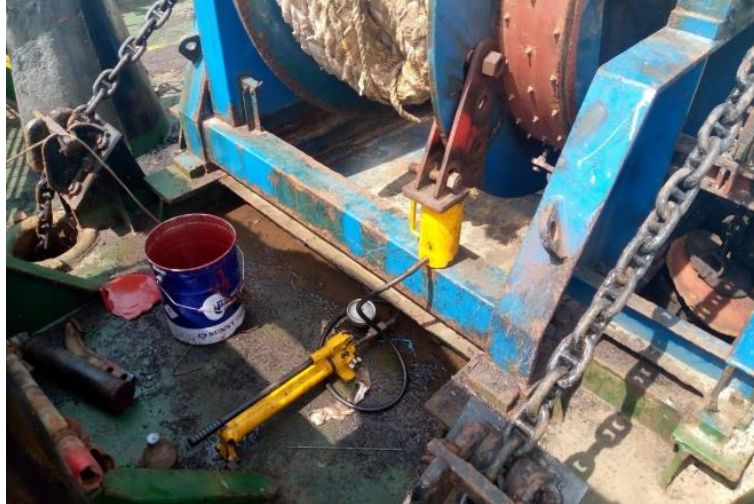
Gambar 2.109 Proses Break Holding Test kapal Transko Murai Sumber : Dokumentasi penulis
