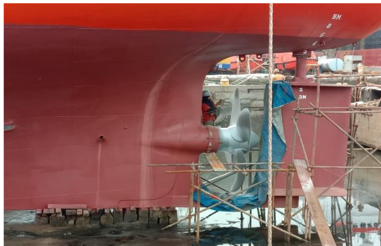
Gambar 2.60 Proses tahap finishing silicon pada propeller kapal Gas Mentaya Sumber : Dokumentasi penulis
