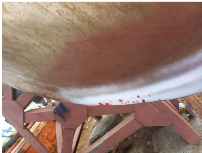
Gambar 2.10 Proses inspeksi propeller kapal MV. Lintas Mahakam Sumber : Dokumentasi penulis
