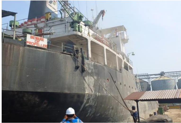
Gambar 2.49 Proses Sand Blasting pada lambung kapal kapal Kurau Sumber : Dokumentasi penulis
