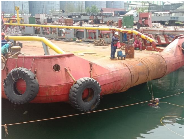
Gambar 2.14 Proses centering kapal terhadap keel block di Graving Dock Sumber : Dokumentasi penulis
