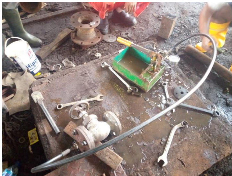
Gambar 2.126 Proses uji coba Valve kapal MV. Dahlia Merah Sumber : Dokumentasi penulis
