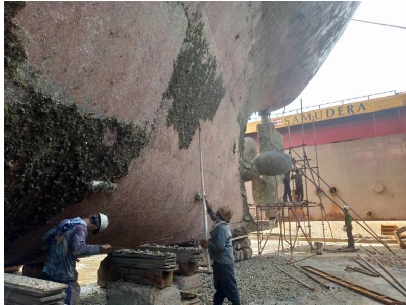
Gambar 2.122 Proses pembersihan Lambung kapal MV. Dahlia Merah Sumber : Dokumentasi penulis
