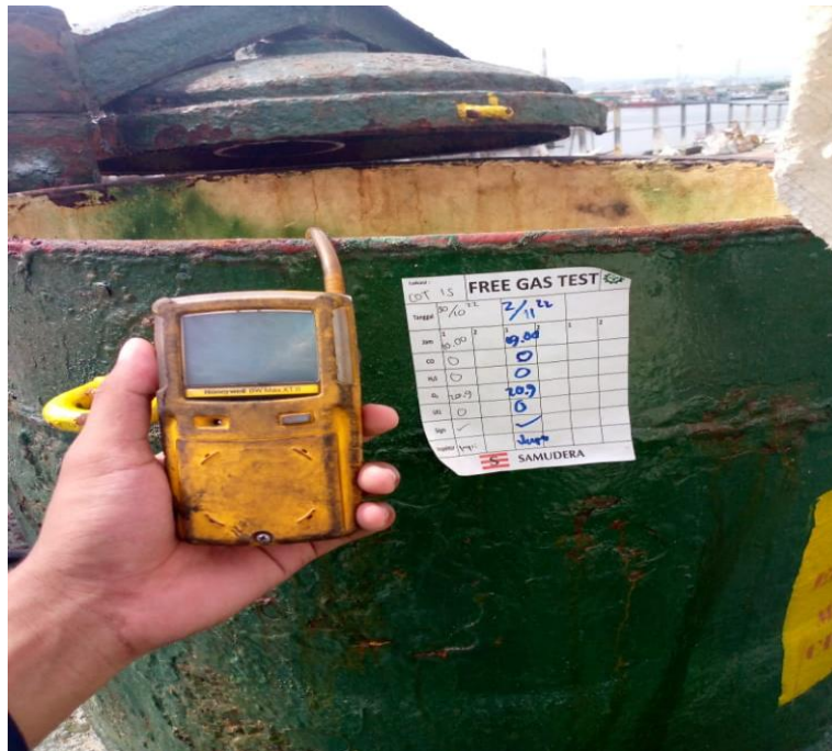
Gambar 2.54 Proses Free Gas test kapal Kurau Sumber : Dokumentasi penulis
