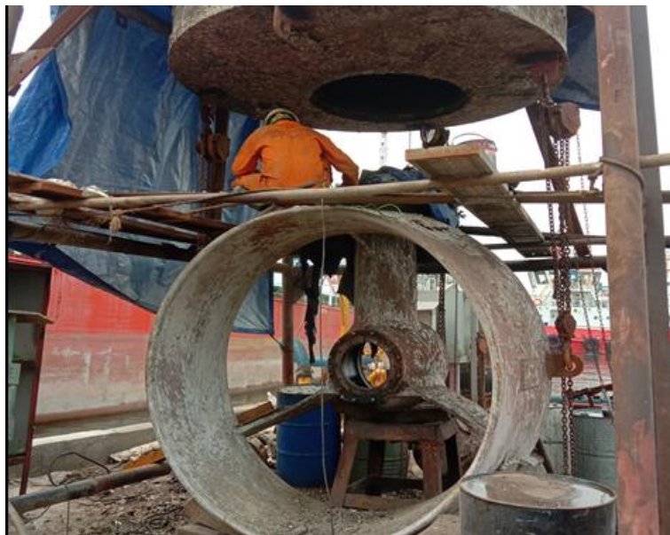
Gambar 2.27 Proses proses pembersihan Azimuth kapal Balongan 1 Sumber : Dokumentasi penulis
