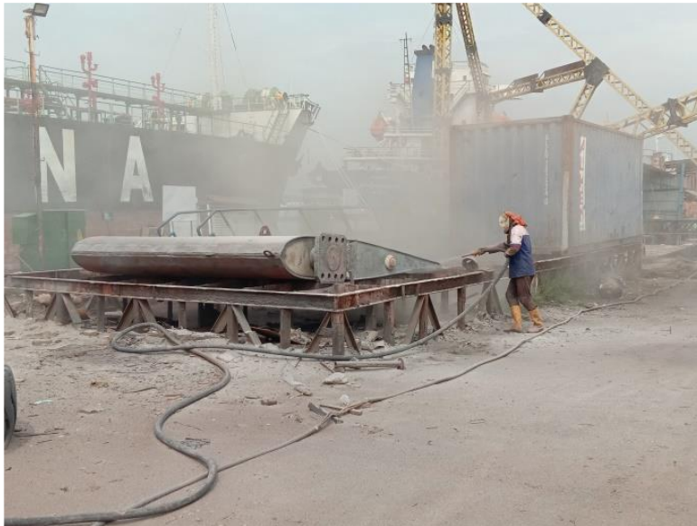
Gambar 2.30 Proses Sand Blasting daun kemudi kapal MV. Lintas Mahakam Sumber : Dokumentasi penulis
