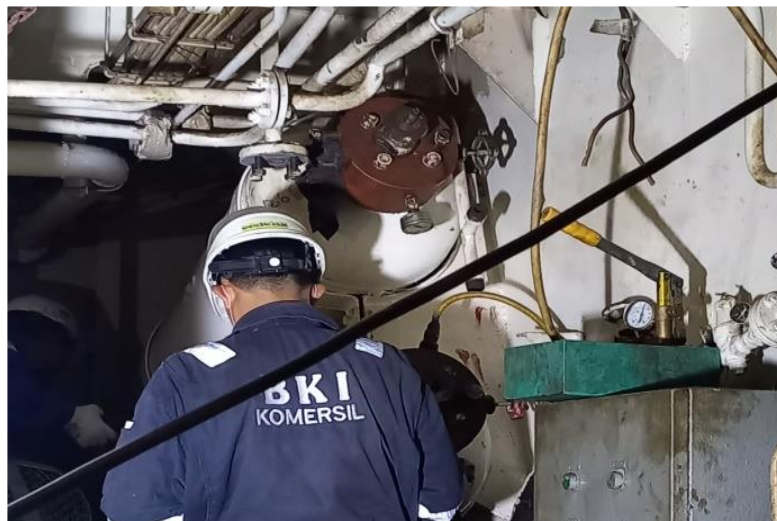
Gambar 2.47 Proses Press Test botol angin kapal TB. Patra Tunda 4201 Sumber : Dokumentasi penulis
