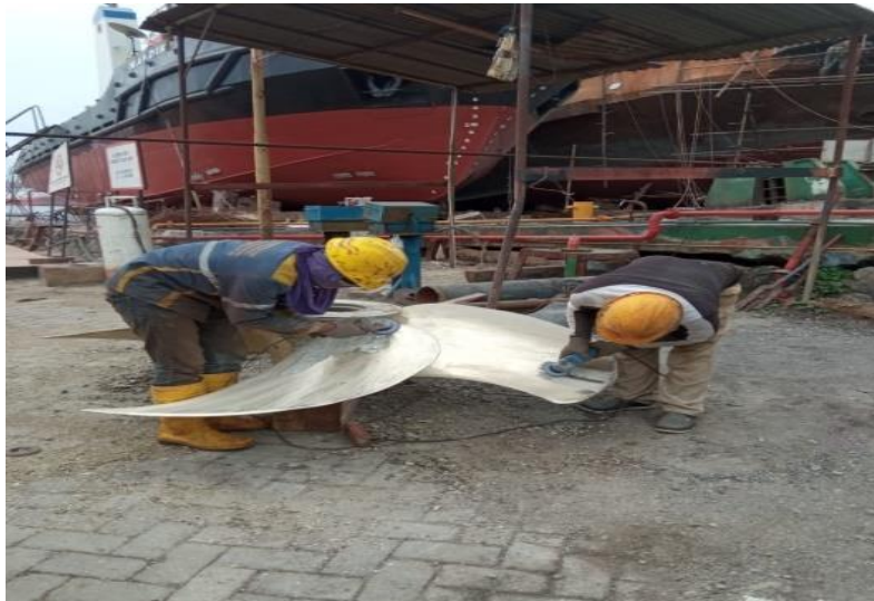
Gambar 2.35 Proses pembersihan propeller kapal Balongan 1 Sumber : Dokumentasi penulis
