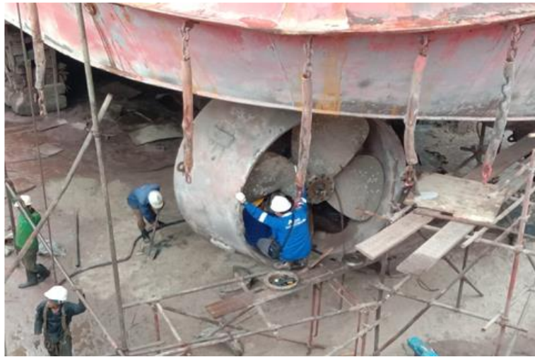
Gambar 2.18 Proses penurunan propeller kapal TB. Patra Tunda 4201 Sumber : Dokumentasi penulis
