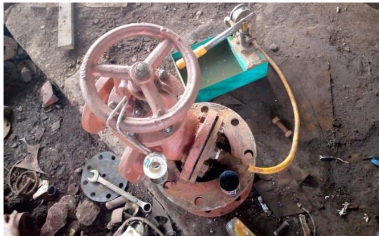
Gambar 2.110 Proses pengujian Valve Sumber : Dokumentasi penulis
