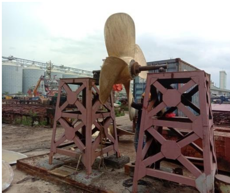
Gambar 2.36 Proses balansir propeller kapal TB. Patra Tunda 4201 Sumber : Dokumentasi penulis
