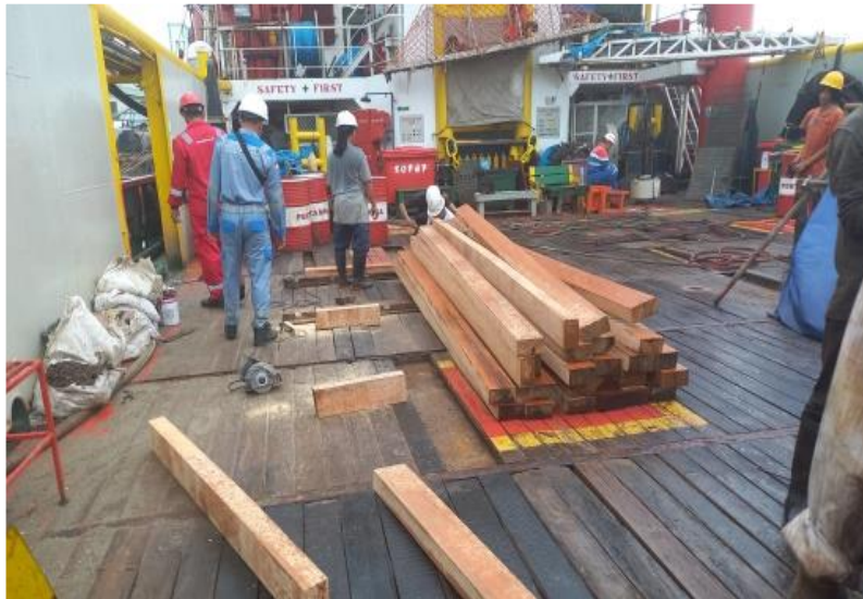
Gambar 2.121 Proses pemasangan papan Deck kapal Transko Andalas Sumber : Dokumentasi penulis
