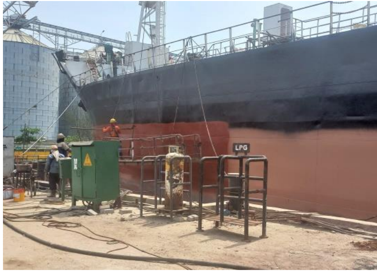
Gambar 2.55 Proses pengecatan Anti Fouling kapal Kurau Sumber : Dokumentasi penulis
