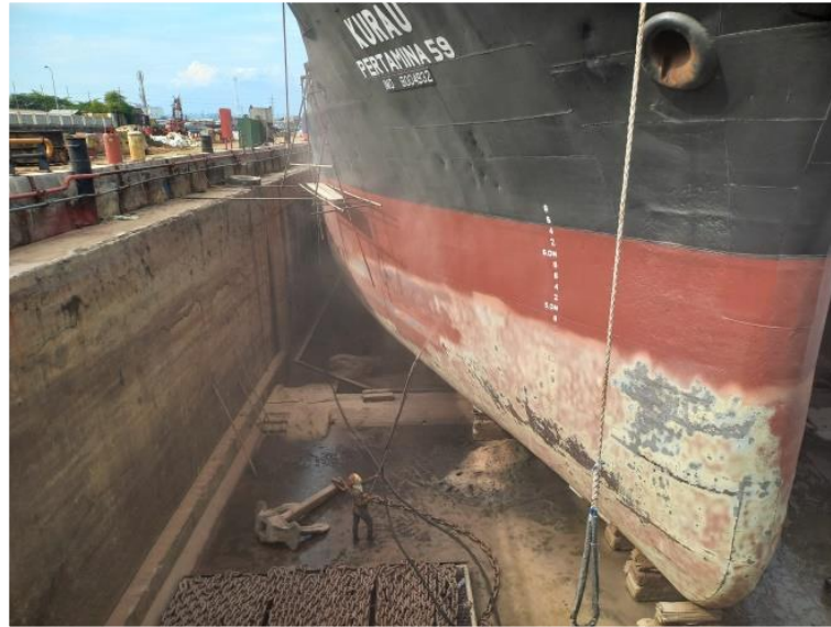
Gambar 2.69 Proses sand blasting kapal MT.Kurau Sumber : Dokumentasi penulis
