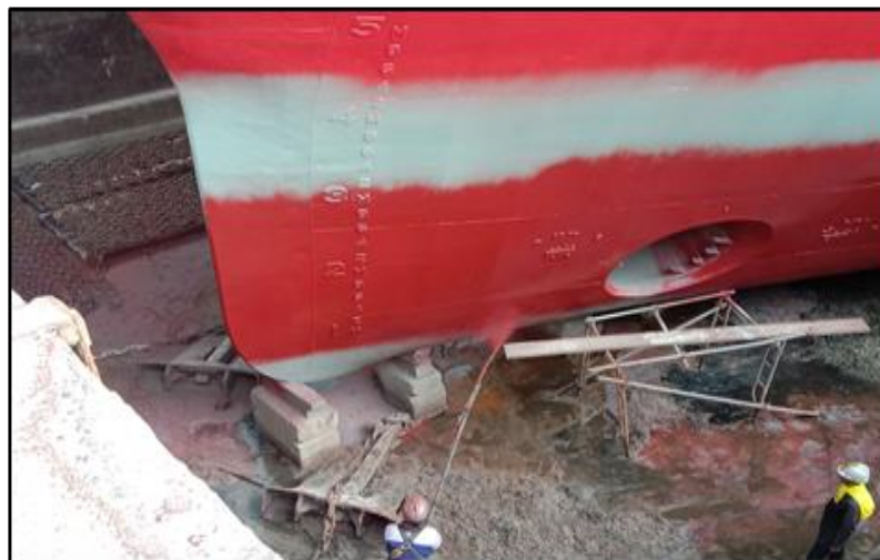
Gambar 2.25 Proses pengecatan Anti Fouling kapal Peteka 5402
