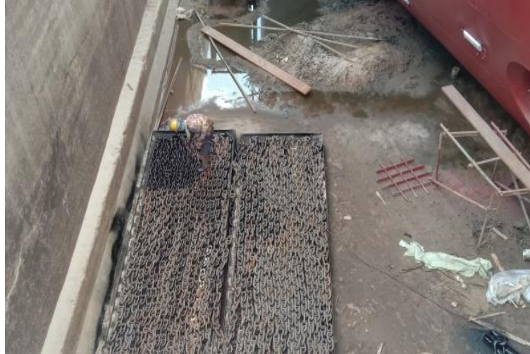
Gambar 2.33 Proses pengecatan rantai jangkar kapal Peteka 5402 Sumber : Dokumentasi penulis
