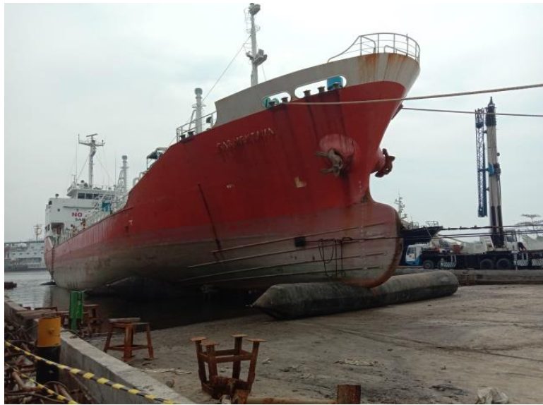
Gambar 2.28 Proses persiapan docking kapal Gas Mentaya Sumber : Dokumentasi penulis
