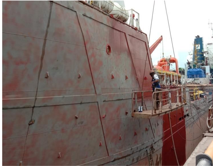
Gambar 2.23 Proses pengecatan AC pada lambung kapal Peteka 5402 Sumber : Dokumentasi penulis
