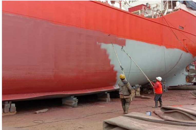
Gambar 2.58 Proses pengecatan Anti Fouling kapal Gas Mentaya
