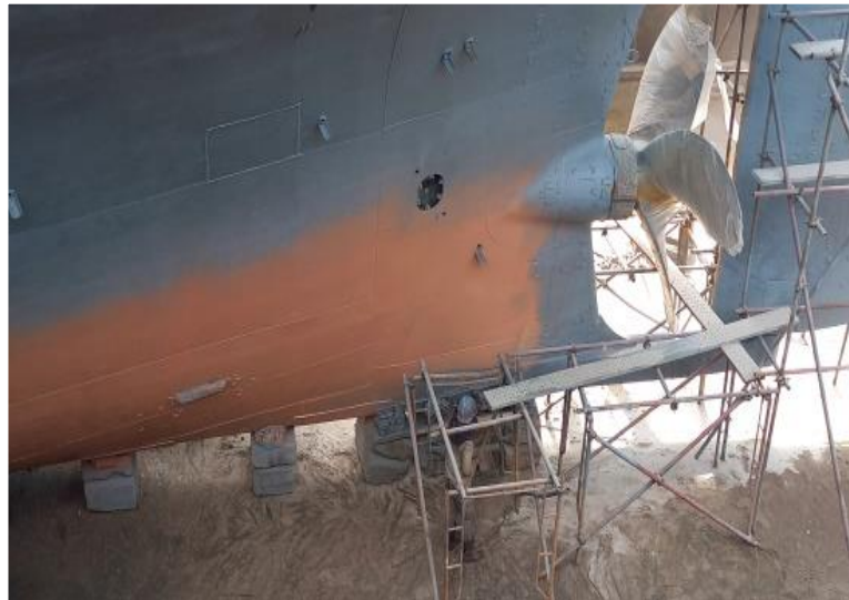
Gambar 2.127 Proses pengecatan kapal MV. Dahlia Merah Sumber : Dokumentasi penulis
