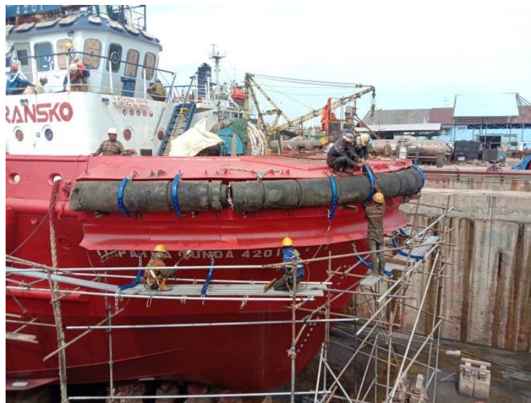
Gambar 2.37 Proses pemasangan rantai Rubber Feeder TB. Patra Tunda 4201
