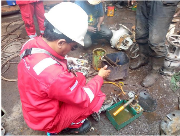
Gambar 2.125 Proses uji coba Valve kapal MV. Dahlia Merah Sumber : Dokumentasi penulis
