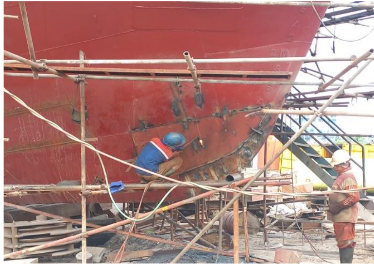
Gambar 2.40 Proses replating pada kapal TB. Balongan 1 Sumber : Dokumentasi penulis
