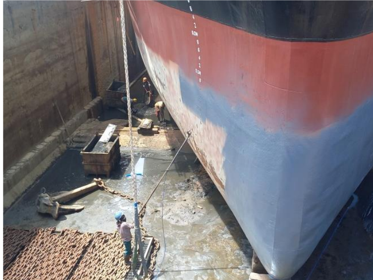
Gambar 2.73 Proses pengecatan AC kapal MT.Kurau Sumber : Dokumentasi penulis
