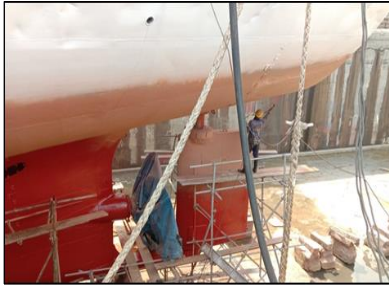
Gambar 2.80 Proses pengecatan kapal sinar Maluku Sumber : Dokumentasi penulis
