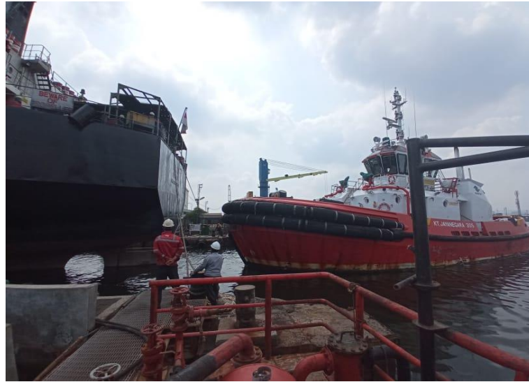
Gambar 2.56 Proses undocking kapal Kurau Sumber : Dokumentasi penulis
