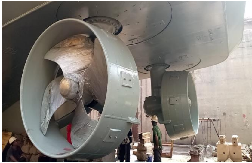
Gambar 2.105 Proses pemutaran Azimuth kapal Transko Murai Sumber : Dokumentasi penulis
