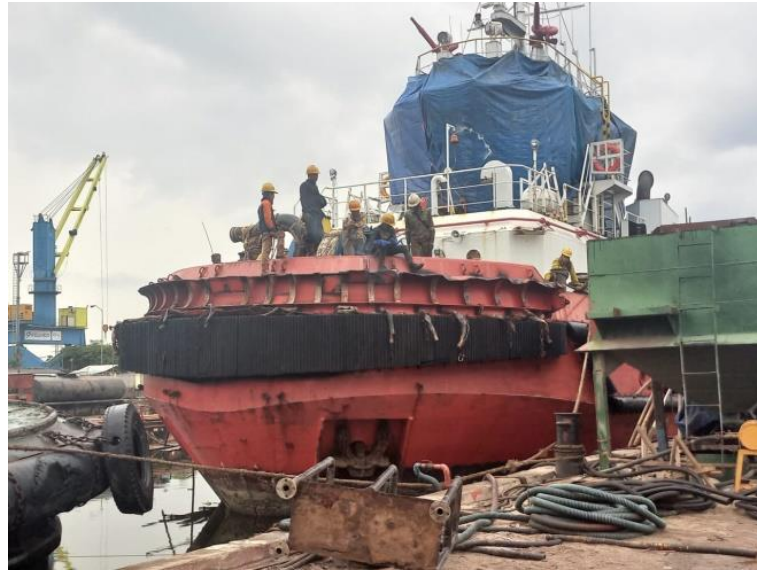
Gambar 2.102 Proses pemasangan Rabber Feeder kapal Transko Murai Sumber : Dokumentasi penulis
