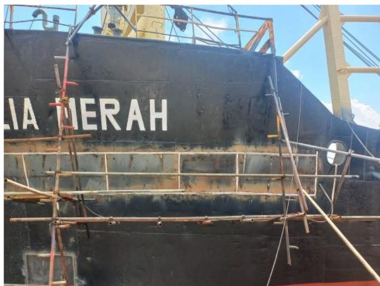
Gambar 2.129 Proses Repleting Haluan kapal MV. Dahlia Merah Sumber : Dokumentasi penulis
