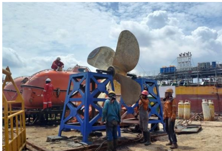
Gambar 2.72 Proses balansir propeller kapal MT.Kurau Sumber : Dokumentasi penulis
