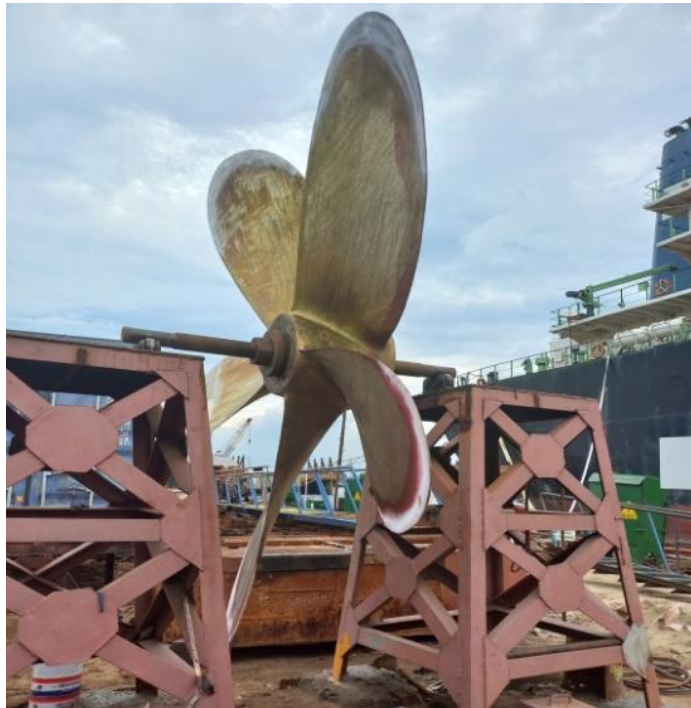
Gambar 2.9 Proses balansir propeller kapal MV. Lintas Mahakam Sumber : Dokumentasi penulis
