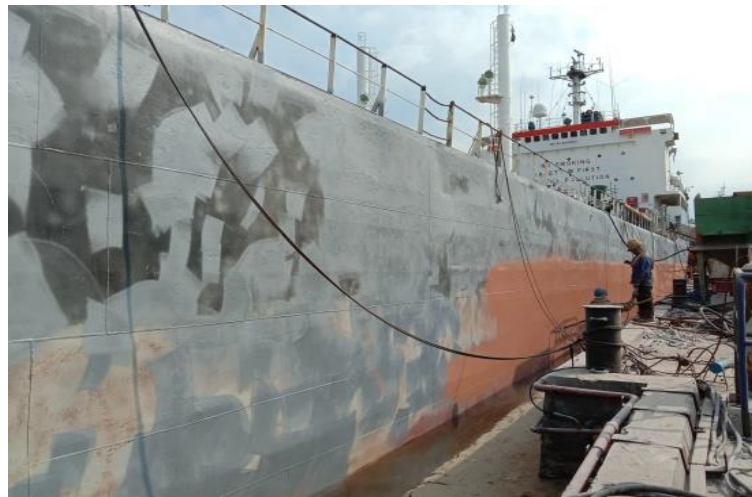
Gambar 2.52 Proses pengecatan Intermediate kapal Kurau Sumber : Dokumentasi penulis
