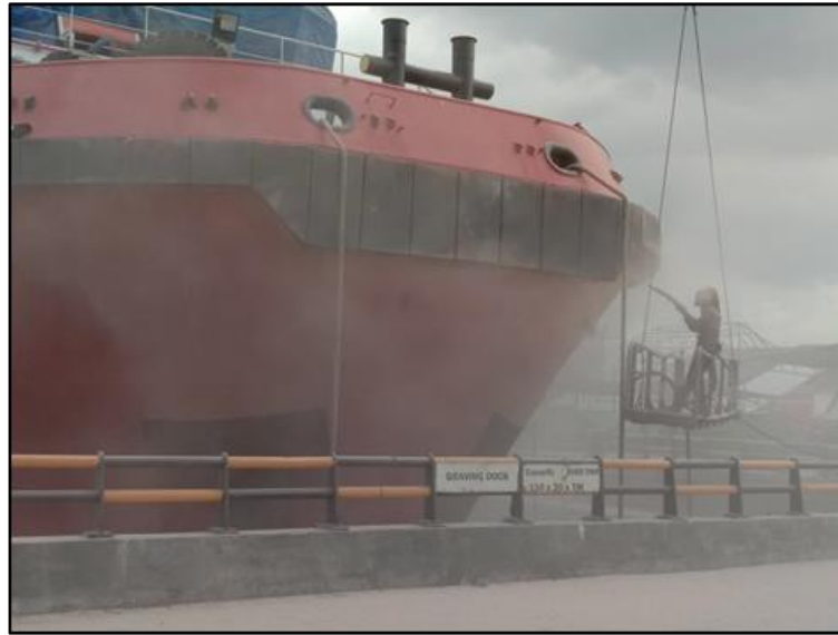
Gambar 2.21 Proses Sand Blasting pada lambung kapal Peteka 5402 Sumber : Dokumentasi penulis
