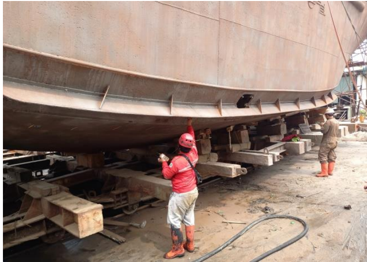
Gambar 2.104 Proses pengukuran ketebalan Plat kapal Permata Dolphin Sumber : Dokumentasi penulis
