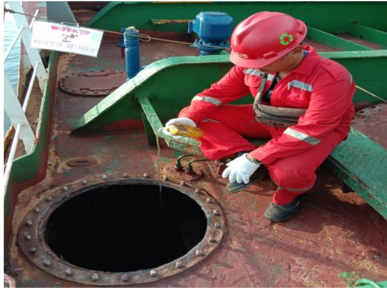
Gambar 2.61 Proses pengecekan Free Gas Test kapal Sinar Maluku Sumber : Dokumentasi penulis
