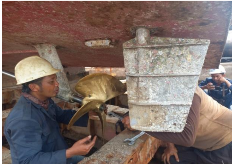
Gambar 2.71 Proses pemasangan shaft dan propeller kapal jaya patriot 12 Sumber : Dokumentasi penulis
