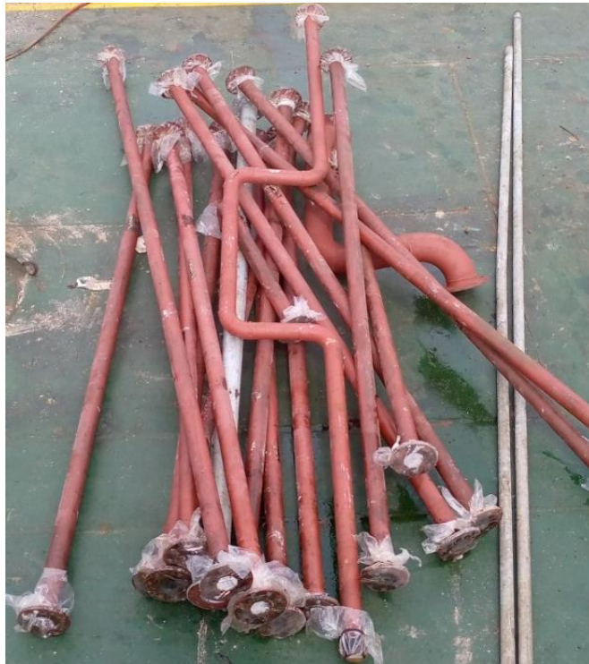
Gambar 2.75 Proses pemasangan Pipa Hidrolik kapal kurau Sumber : Dokumentasi penulis
