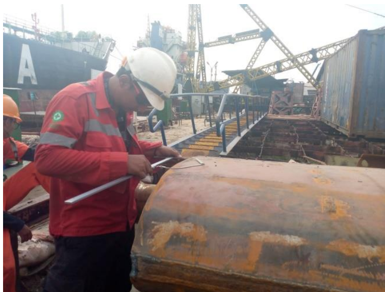
Gambar 2.17 Proses pengukuran diameter kemudi kapal MV. Lintas Mahakam Sumber : Dokumentasi penulis
