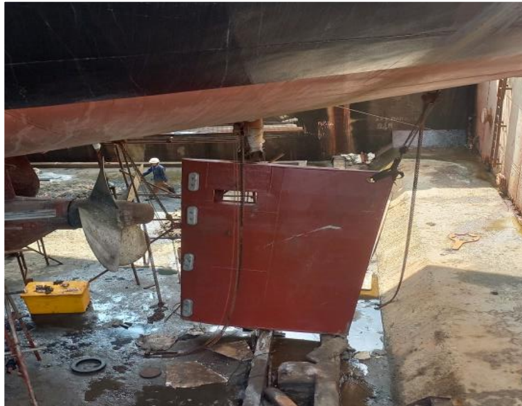
Gambar 2.66 Proses pemasangan daun kemudi kapal MT. Ketaling Sumber : Dokumentasi penulis
