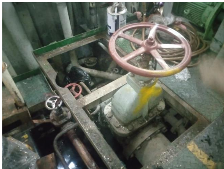
Gambar 2.92 Proses pelepasan Valve Sea Chest kapal Transko Murai Sumber : Dokumentasi penulis
