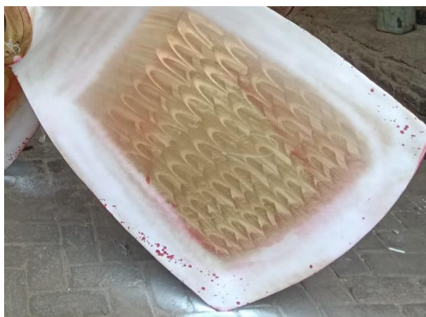
Gambar 3.21 Terdapat Crack dari Hasil Pengujian
