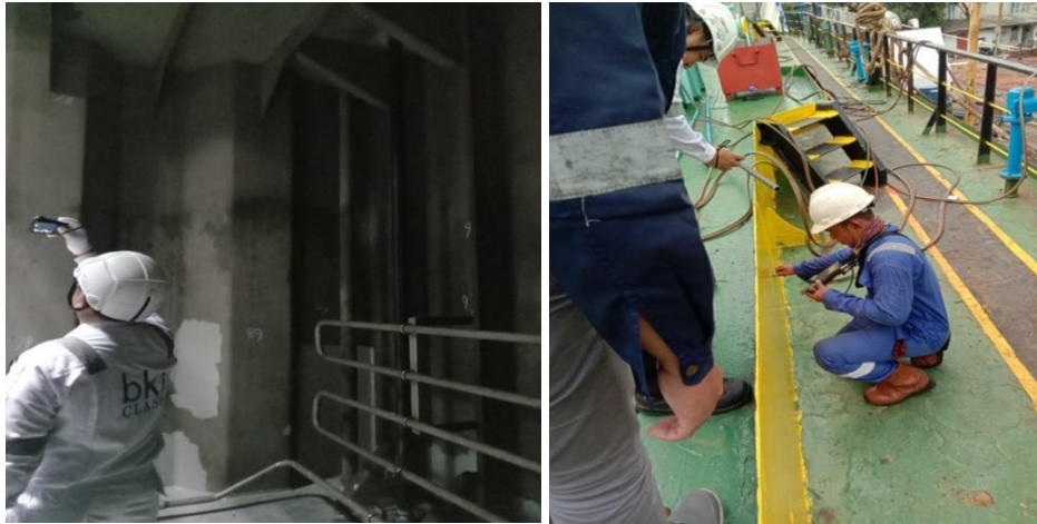
Gambar 2.46 Pemeriksaan Internal COT dan Proses UT MT. SAMUGARA 77
