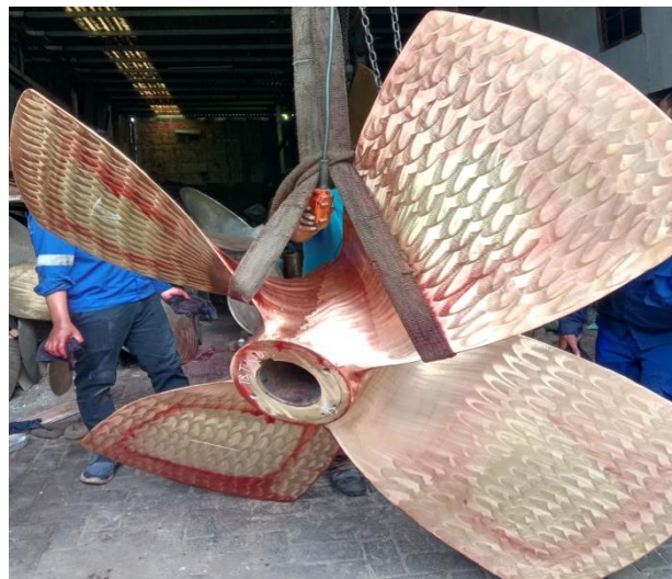
Gambar 3.19 Pembersihan dari Red Penetrant
