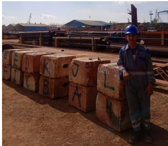
Gambar 3.3 Beban untuk inclining test
