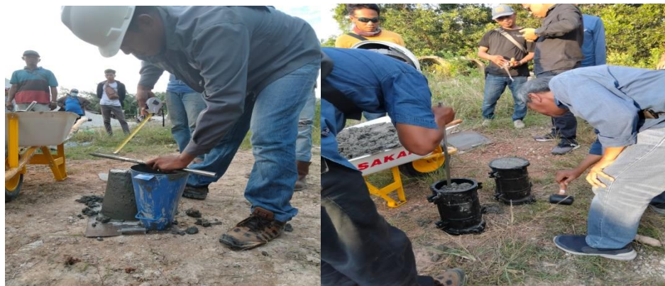
Gambar 1. 8 pengujian slump dan pengujian silinder
