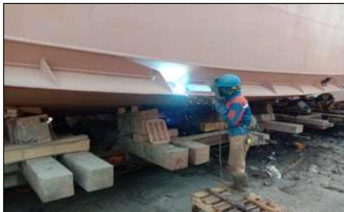
Gambar 2.119 Proses pemasangan zinc anode
