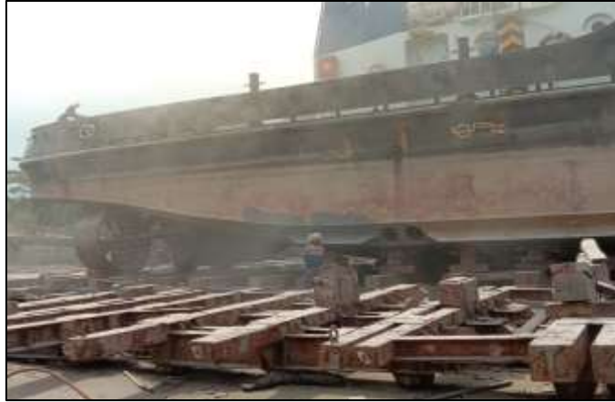
Gambar 2.86 Proses sand blasting pada kapal Duta Kapuas 25
