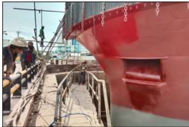
Gambar 2.130 Proses pengecatan tahap finishing
