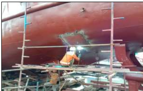
Gambar 2.125 Proses pengerjaan replating pada kapal TB. Sandia IV
