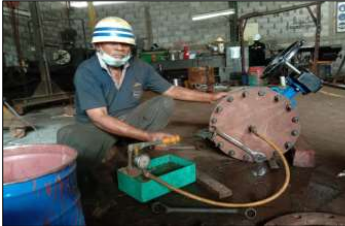
Gambar 2.99 Proses pengujian kekedapan valve butterfly
