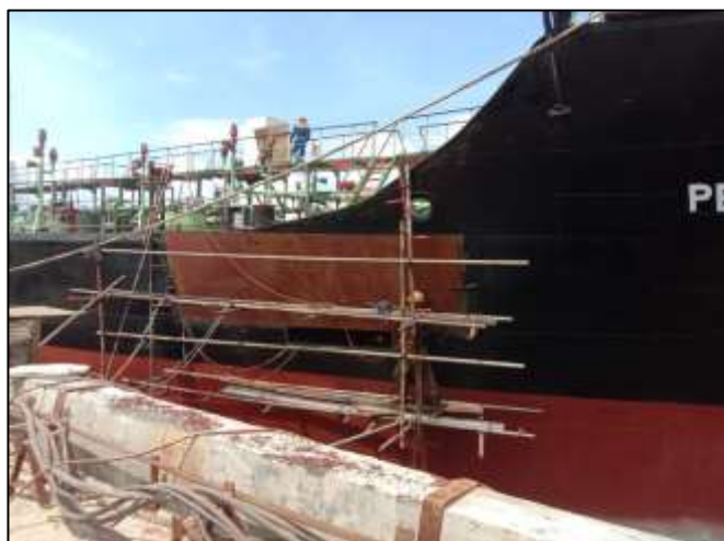
Gambar 2.75 Proses pekerjaan replating kapal MT. Kurau
