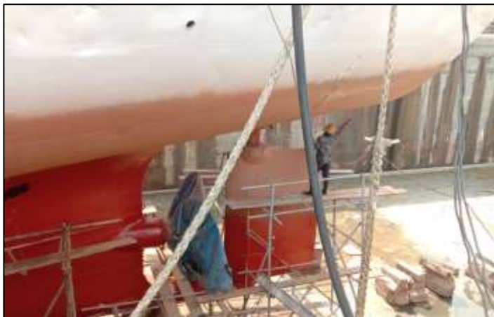
Gambar 2.85 Proses pengecatan anti fouling kapal Sinar Maluku
