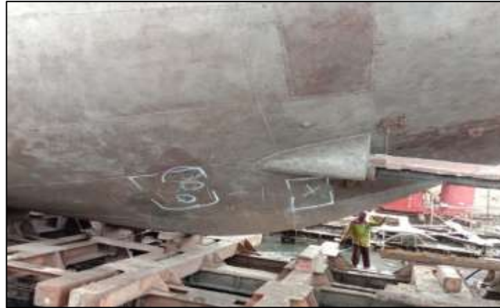
Gambar 2.122 Proses penandaan plat yang akan di replating
