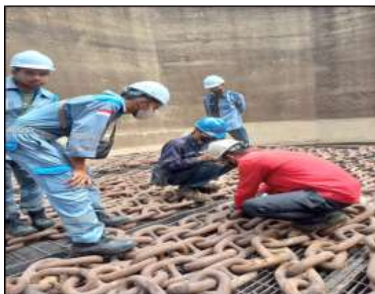
Gambar 2.3 Proses inspeksi rantai jangkar kapal MV. Lintas Mahakam Sumber : Dokumentasi penulis
