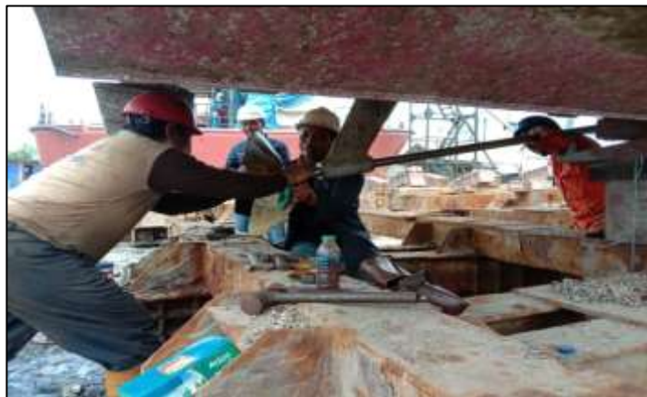
Gambar 2.71 Proses pemasangan shaft dan propeller
