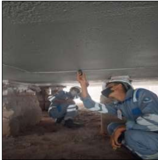
Gambar 2.2 Proses pengukuran panjang dan lebar plat di lambung kapal Sumber : Dokumentasi penulis
