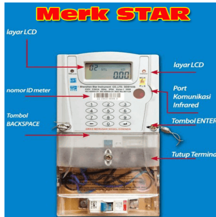
Gambar 3.3 kwh Meter merk star
