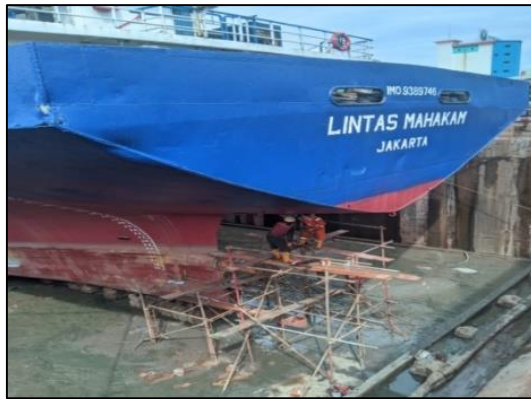
Gambar.2.56 Persiapan pemasangan Rudder Stock kapal MV. Lintas Mahakam. Sumber : Dokumentasi penulis.
