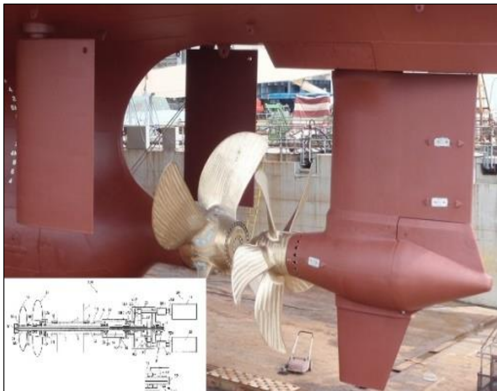
Gambar 3.5 Bentuk Contra Rotating Propeller Sumber : Wikipedia
