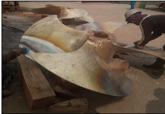
Gambar 2.91 Cleaning propeller kapal TB Transko Murai dan Wallet. Sumber : Dokumentasi penulis.
