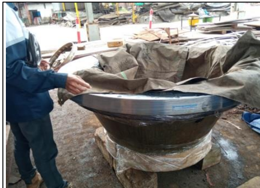
Gambar.2.48 Swivle Gear Bearing yg sudah di pasang. Sumber : Dokumentasi penulis.
