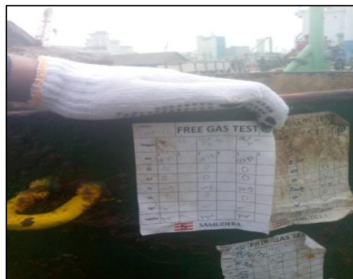
Gambar.2.74 Proses pengecekan Free Gas Test pada tangki kapal kurau (Pertamina 59). Sumber : Dokumentasi penulis.
