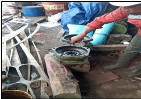
Gambar.2.52 Proses pemasangan bearing shaft propeller untuk kapal TB. Balongan 1. Sumber : Dokumentasi penulis.
