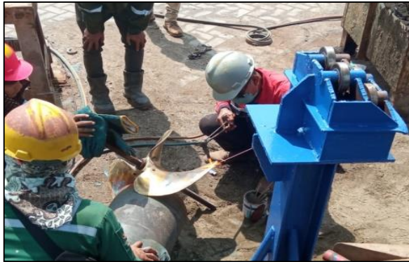
Gambar.2.59 Proses penambahan daging pada propeller kapal Jaya Patriot 12. Sumber : Dokumentasi penulis.
