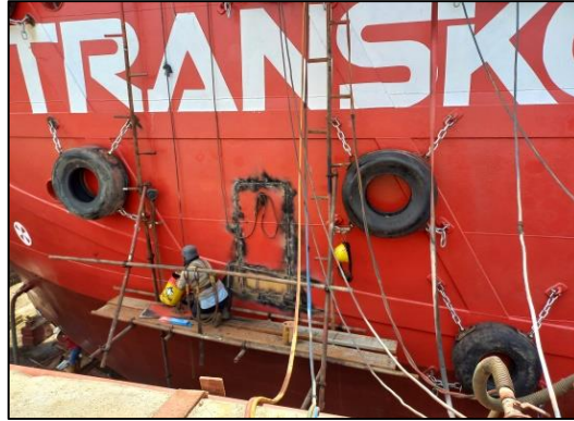
Gambar 2.109 Replating pada lambung kapal Transko Andalas. Sumber : Dokumentasi penulis.
