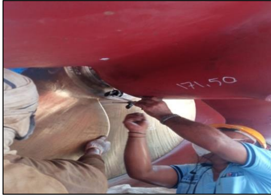
Gambar 2.97 Proses centring leaner Deal gauge pada propeller kapal tb. transko murai. Sumber : Dokumentasi penulis.
