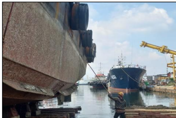
Gambar.2.66 Pembersihan lambung kapal TB. Mitra Bahari. Sumber : Dokumentasi penulis.
