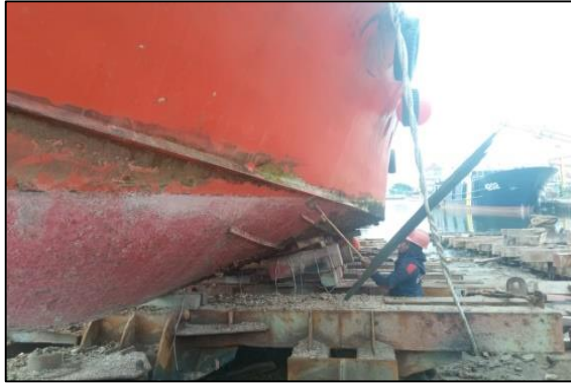
Gambar.2.58 Pembersihan lambung kapal Jaya Patriot 12. Sumber : Dokumentasi penulis.
