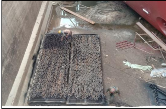
Gambar.2.44 Proses pengecatan ( painting ) rantai jangkar kapal Peteka 5402. Sumber : Dokumentasi penulis.
