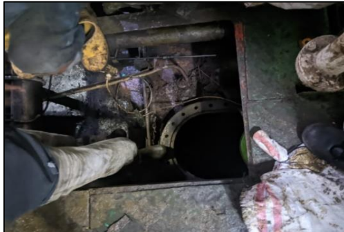
Gambar.2.31 Pembersihan tangki minyak (oil tank) kapal Tb. Patra Tunda 4201. Sumber : Dokumentasi penulis.
