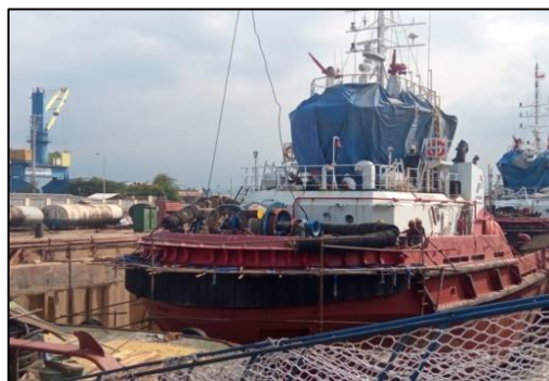
Gambar 2.96 Proses pemasangan rubber fender untuk kapal Tb. transko murai. Sumber : Dokumentasi penulis.
