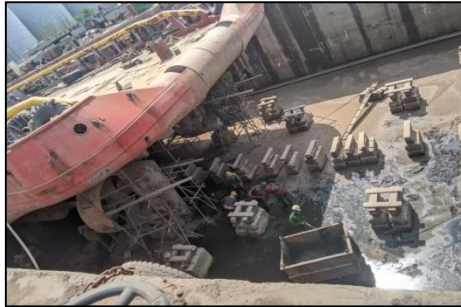
Gambar.2.21 Pembersihan pasir hasil dari sandblasting kapal PETEKA 5402 Sumber : Dokumentasi penulis.
