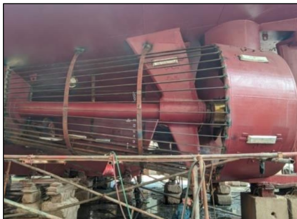
Gambar.2.49 Pengelasan z peller pada kapal peteka 5402. Sumber : Dokumentasi penulis.
