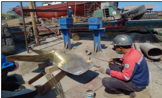
Gambar 2.102 Proses penambahan daging pada propeller kapal TB.Sandia IV. Sumber : Dokumentasi penulis.
