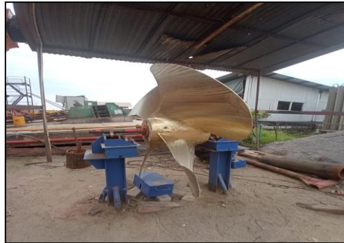
Gambar 2.94 Pengaplikasian cat pernis pada propeller Sumber : Dokumentasi penulis.
