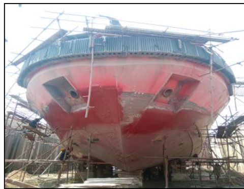
Gambar 2.90 Pengelasan untuk pelepasan zinc anode pada kapal TB. Wallet Sumber : Dokumentasi penulis.
