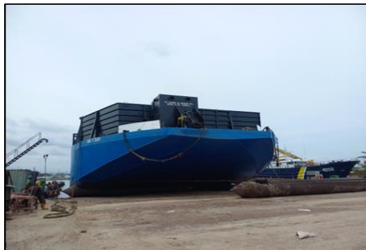
Gambar 2.105 Proses undocking kapal Tongkang BKT 301. Sumber : Dokumentasi penulis.
