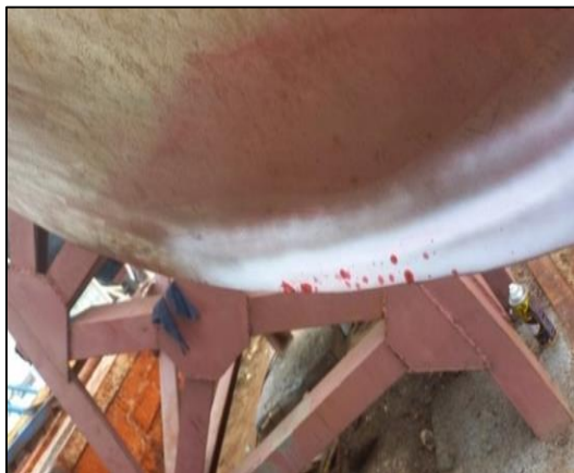
Gambar.2.12 Proses inspeksi propeller dengan metode Penetran Test. Sumber : Dokumentasi penulis.
