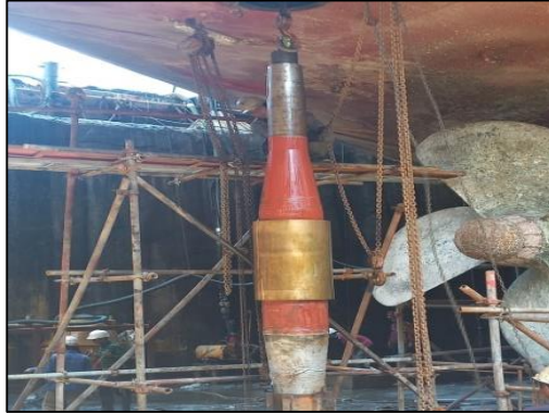
Gambar.2.67 Pemasangan poros kemudi ( rudder stock ) kapal MT. Ketaling. Sumber : Dokumentasi penulis.
