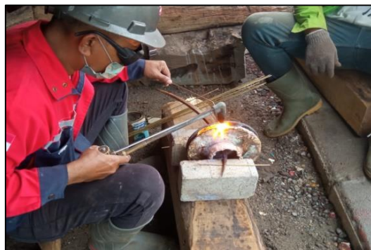
Gambar 2.111 Penambahan daging untuk impeller Kapal Tb sandia IV Sumber : Dokumentasi penulis.
