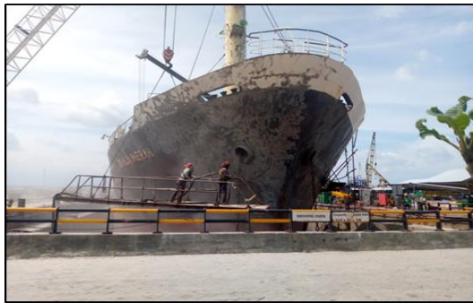
Gambar 2.113 Sandblating kapal Mv. Dahlia Merah Sumber : Dokumentasi penulis.
