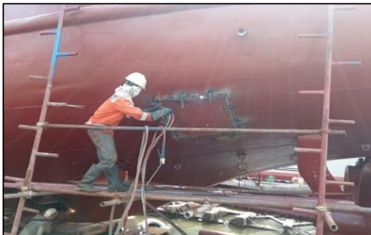
Gambar 2.101 Replating bagian buritan kapal Tb. Sandia IV. Sumber : Dokumentasi penulis.
