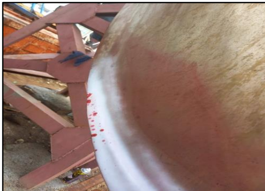
Gambar 3.30 cacat las yang timbul Sumber : Dokumentasi penulis.
