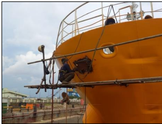
Gambar.2.80 Proses replating bagian haluan kapal sinar maluku. Sumber : Dokumentasi penulis.
