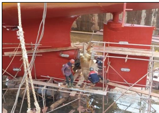
Gambar.2.78 Proses pengaplikasian cat pernis pada propeller kapal Sinar Maluku. Sumber : Dokumentasi penulis.
