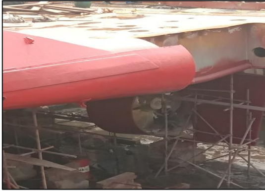
Gambar.2.41 proses repair Stern Roller kapal Peteka 5402. Sumber : Dokumentasi penulis.
