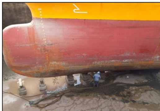
Gambar.2.75 Proses pembersihan lambung kapal Sinar Maluku. Sumber : Dokumentasi penulis.
