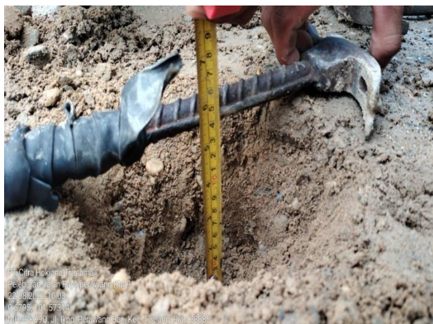
Gambar 3. 17 Test Pit pada Agregat Kelas A Sumber: Dokumentasi lapangan, 2022
