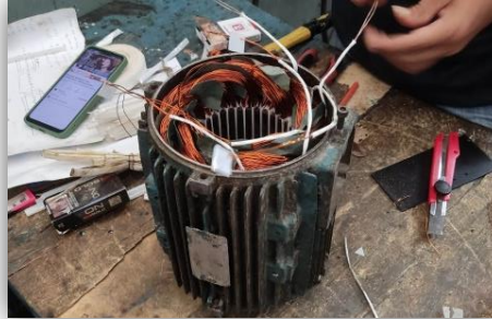
Gambar 3.24 Penyambungan kawat email per fasa (Sumber: Dokumentasi, 2022)
