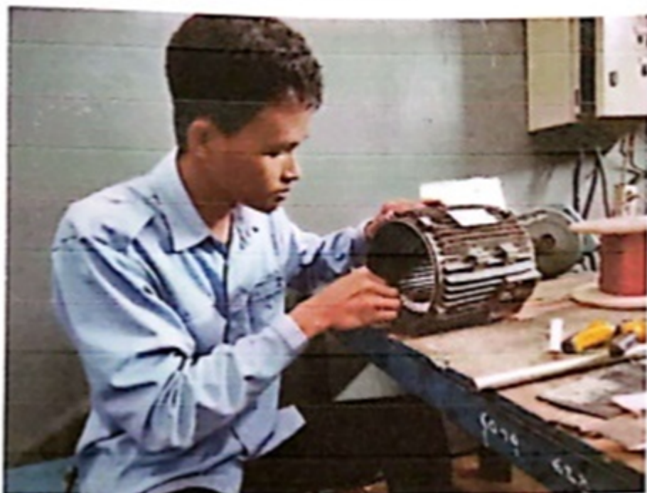
Gambar. Perbaikan elektromotor
