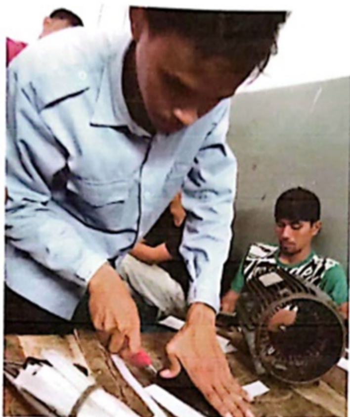
Gambar. Memotong prespan plastik
