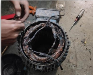
Gambar 3.13 Gulungan terbakar (Sumber: Dukumentasi, 2022)
