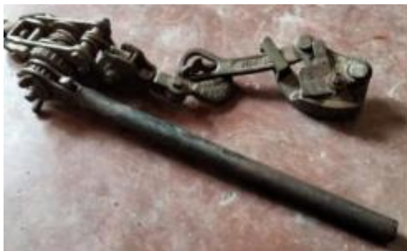
Gambar 2.5. Kontrek ( Sumber : dokumentasi,2022 )
