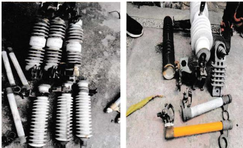
Gambar 2.6. FCO dan Lighting Arrester yang rusak
