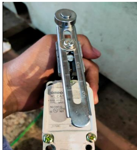
Gambar 2. 25 Replace Limit Switch (Sumber: Dokumentasi, 2022)
