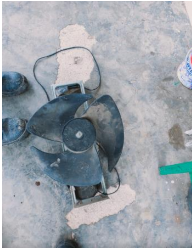
Gambar 2. 18 Merangkai Kipas Angin Dari Outdoor AC (Sumber: Dokumentasi 2022)
