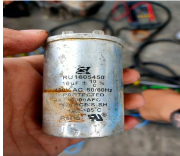
Gambar 2. 4 Replace Kapasitor Non Polar ( Sumber: Dokumentasi, 2022 )
