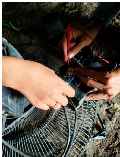
Gambar 2. 19 Maintenance Kipas Angin (Sumber: Dokumentasi 2022)
