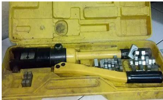
Gambar 2. 43 tang press hidrolik (Sumber: Dokumentasi 2022)
