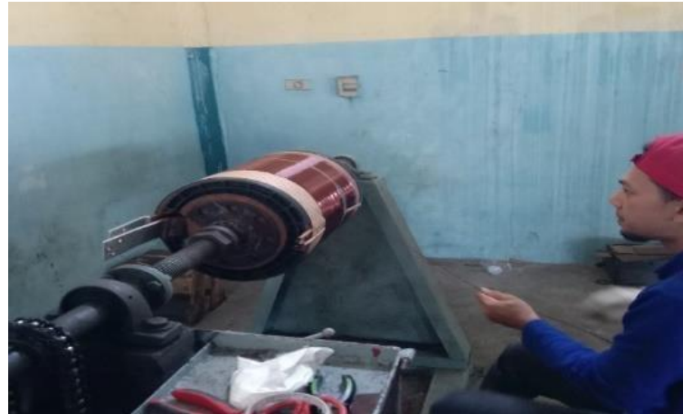
Gambar 2. 11 ganti kawat coil (Sumber: Dokumentasi 2022)
