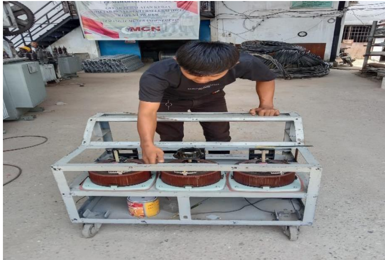
Gambar 2. 38 pemasangan kumparan (Sumber: Dokumentasi 2022)
