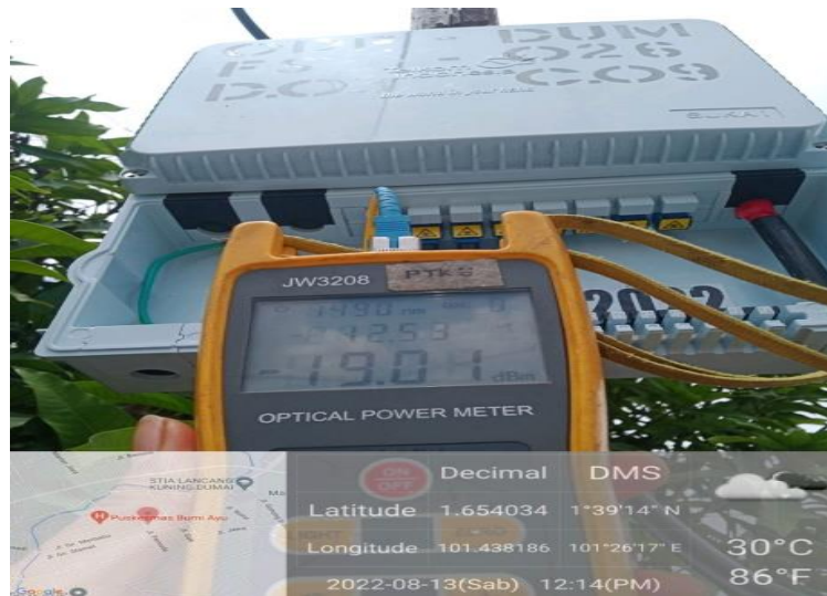
Gambar 3.3 Pengecekan Redaman ODP Sumber:(Dokumentasi,2022)
