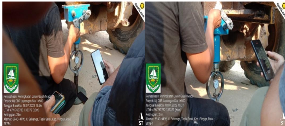
Gambar 3. 48 Pengujian CBR Sumber : Dokumentasi Lapangan, 2022
