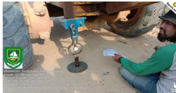
Gambar 3. 10 Alat Uji CBR Lapangan Sumber : Dokumentasi Lapangan, 2022
