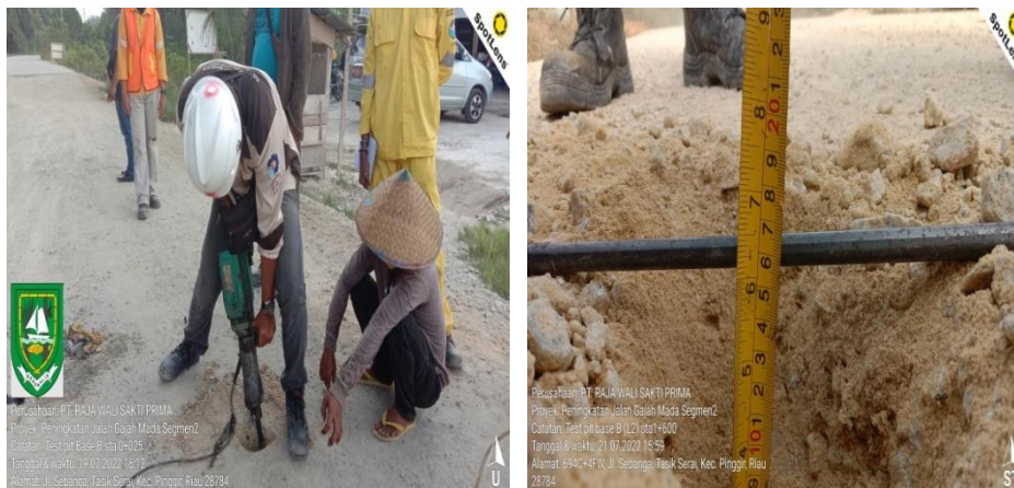
Gambar 3. 49 Test Pit dan Hasilnya Sumber : Dokumentasi Lapangan, 2022
