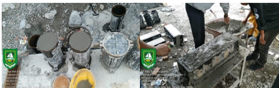
Gambar 3. 26 Pembuatan sampel beton fs 45
