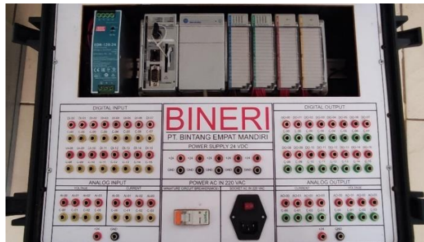
Gambar 2. 2 Modul PLC Allan Bradley (Sumber: PT.Bintang Empat Mandiri, 2022)
