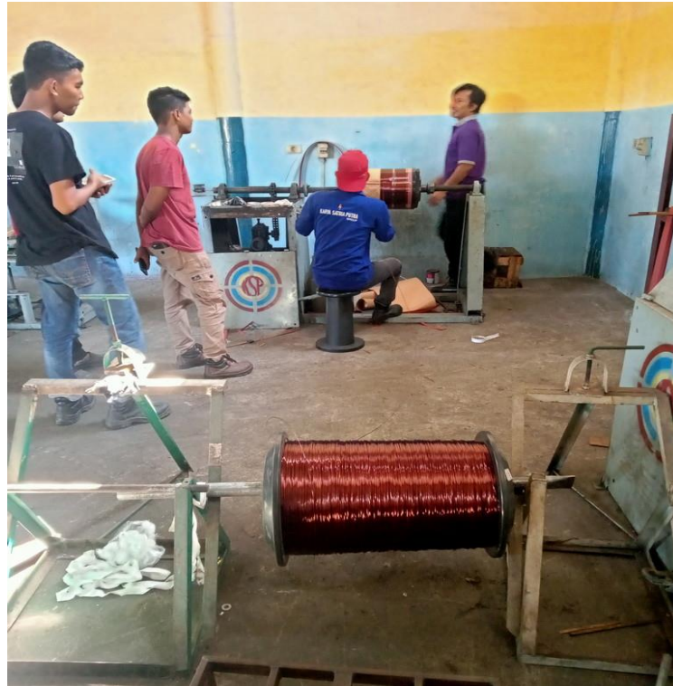
Gambar 2. 7 Pemberian materi mengenai Rewinding Trafo (Sumber : Dokumentasi, 2022)
