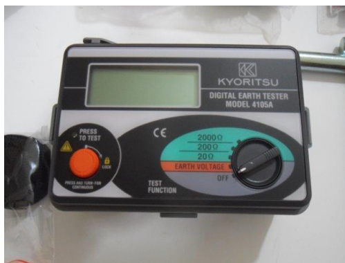
Gambar 2. 34 Earth Tester (Sumber : Dokumentasi, 2022)
