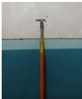
Gambar 2. 32 Stick 20 Kv (Sumber: Dokumentasi, 2022)
