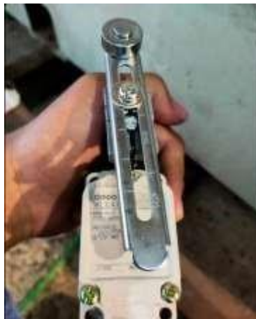
Gambar 2.21 Photo limit switch (Sumber:dokumentasi, 2022)
