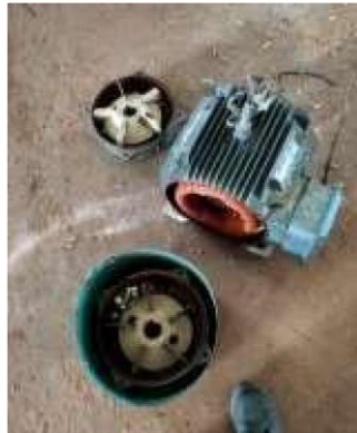
Gambar 2.5 Photo install motor 3 phasa (sumber:dokumentasi, 2022)
