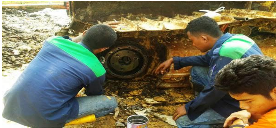
Gambar 4.2 Memeriksa ketegangan track (sumber. Dokumentasi pribadi penulis,2021)
