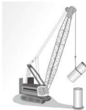
Gambar 3. 6 Pengangkatan Pile Yang Sudah Di Potong
