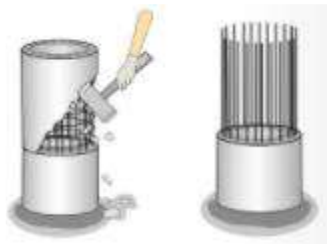
Gambar 3. 8 Pembobokan Pile Cap
