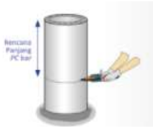
Gambar 3. 7 Membuat Perencanaan Tiang Yang Hendak Di Potong
