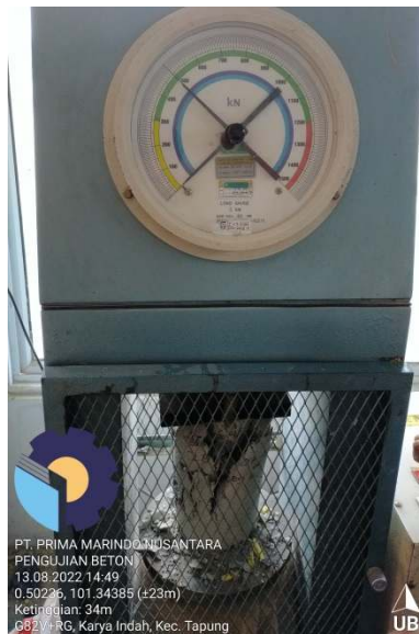
Gambar 3. 24 Pengujian beton silinder fc 36 (Sumber: Dokumentasi Lab LUTVINDO PKU)
