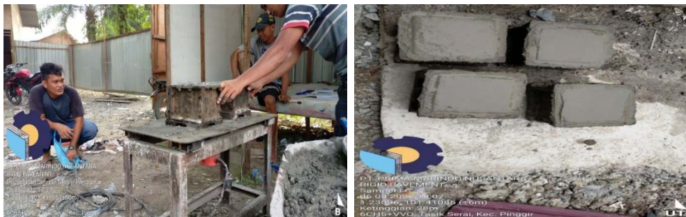
Gambar 3. 16 Pembuatan sampel untuk uji kuat tekan kubus Lean oncrete (Sumber : Dokumentasi Lapangan, 2022)
