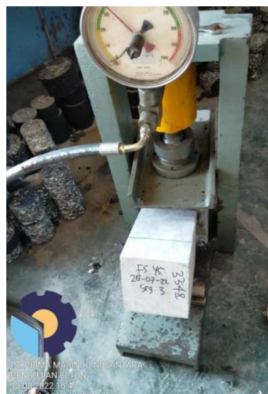
Gambar 3. 25 Pengujian beton balok fs 45 (Sumber: Dokumentasi Lab LUTVINDO PKU)
