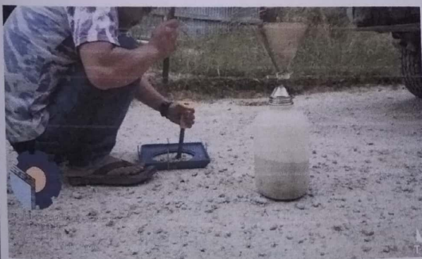
Pekerjaan Uji Sand Cone
