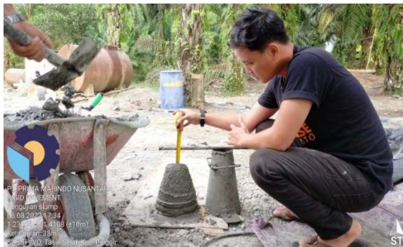
Gambar 3.13 Pengujian Slump Lean Concrete (Sumber : Dokumentasi Lapangan, 2022)
