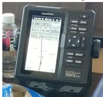
Gambar 3.6 Pola Gerakan Kapal Saat Steering Gear Test
