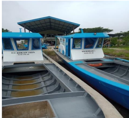
Gambar 2. 82 Finishing Kapal 5 GT Yang Pertama Dan Kedua
