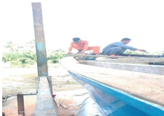
Gambar 2. 56 Pekerjaan Laminasi Fender
