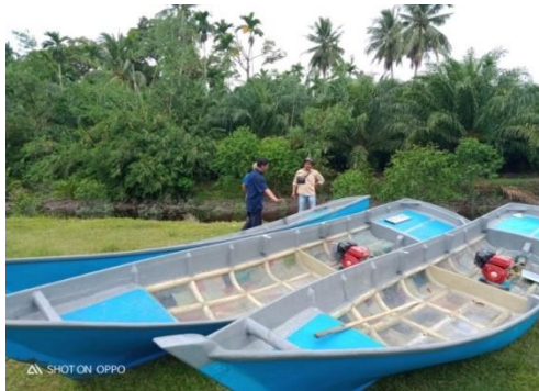
Gambar 2. 31 Pemasangan Tapak Mesin Robin pada Perahu Nelayan
