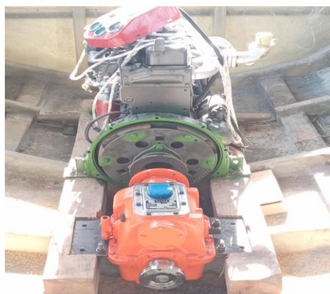
Gambar 3. 3 Pemasangan Gear Box
