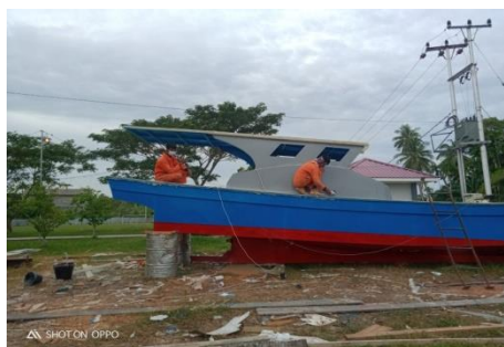
Gambar 2. 71 Pengecatan bangunan atas Kapal 4 GT
