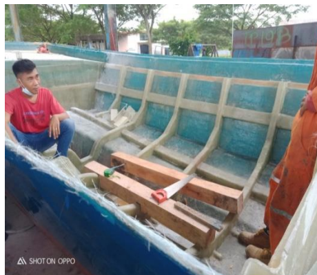
Gambar 3. 1 Menentukan pondasi mesin yang tepat ( accurate )
