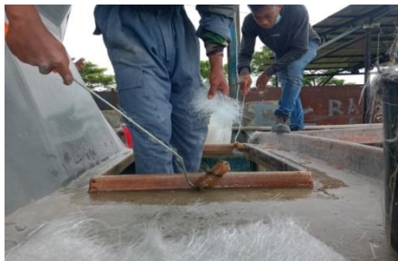
Gambar 2. 51 Pembuatan Chain Locker
