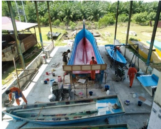
Gambar 2. 34 Pengerjaan Gelcoat warna Merah dan Biru pada kapal 5 GT yang kedua
