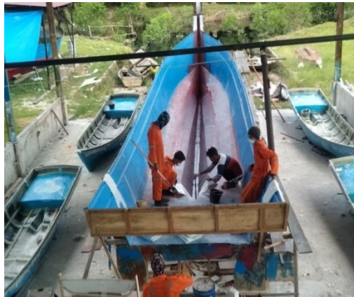
Gambar 2. 35 Proses Laminasi Keel/lunas pada Kapal 5 GT yang kedua
