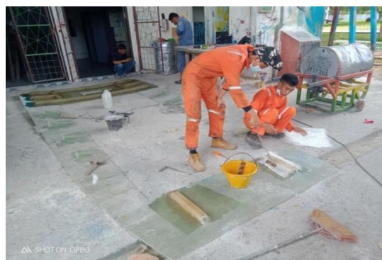
Gambar 2. 48 Pembuatan dan Laminasi Bracket
