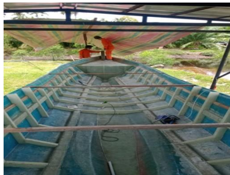
Gambar 2. 38 Pekerjaan Lanjutan Pemasangan Gading Memanjang Kapal 5 GT
