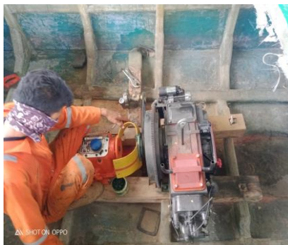
Gambar 3. 6 Pemasangan pompa siput
