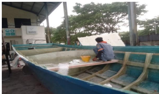
Gambar 2. 40 Pembuatan Sekat Kamar Mesin
