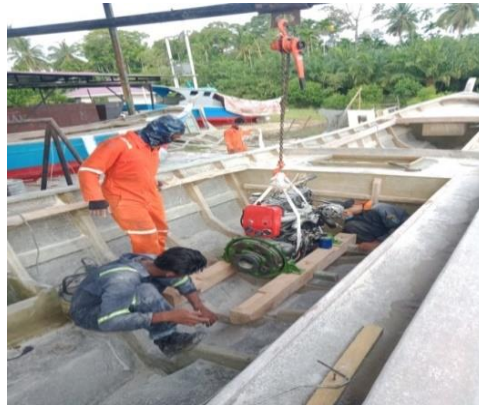
Gambar 2. 68 Laminasi tapak/pondasi Mesin 48 PK
