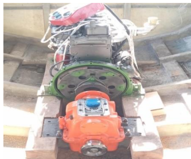
Gambar 3. 7 Pemasangan selang dan pipa pada motor penggerak diesel 48 PK
