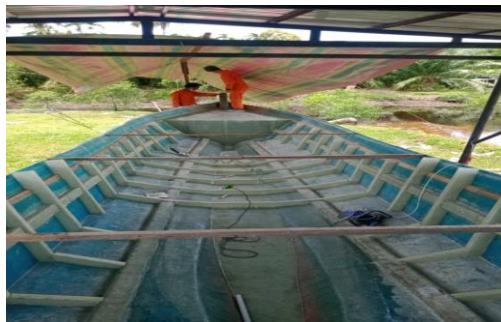
Gambar 2. 37 Pemasangan Gading Memanjang Kapal 5 GT
