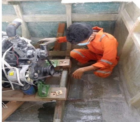
Gambar 3. 2 Penentuan kedudukan Sumbu Baling-baling ( Propeller )
