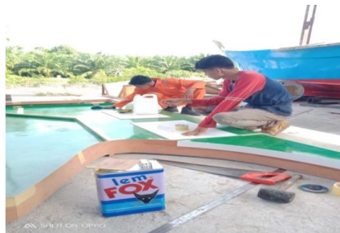
Gambar 2. 54 Pekerjaan Laminasi Bangunan Atas Kapal 5 GT
