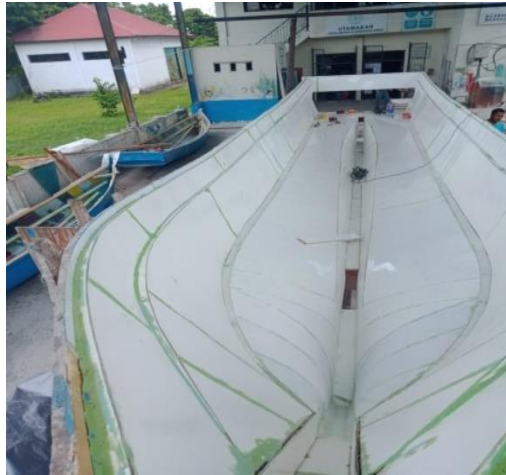
Gambar 2. 16 Repair Cetakan kapal 5 GT
