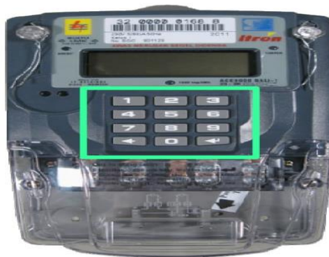
Gambar 3.7 Papan Tombol Kwh (Sumber: Dokumentasi, 2022)
