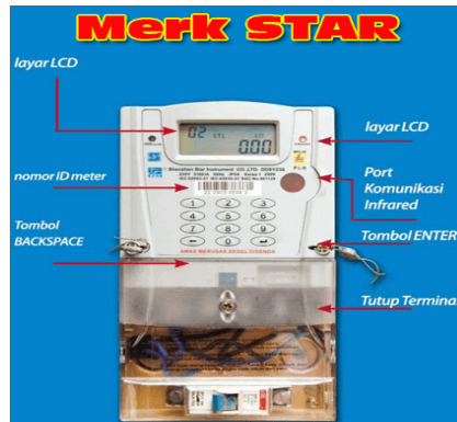
Gambar 3.3 kwh Meter Merk Star (Sumber: Dokumentasi, 2022)
