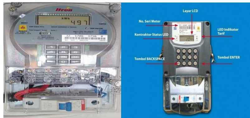
Gambar 3.1 kWh Meter merk Itron (Sumber: Dokumentasi, 2022)
