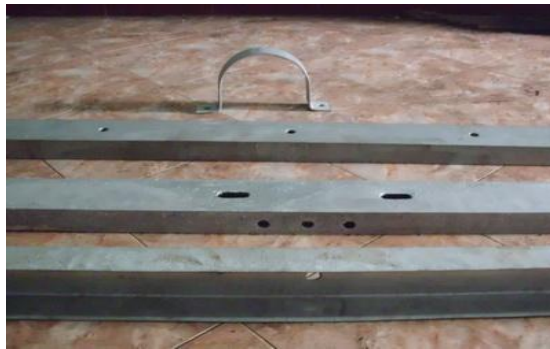
Gambar 3. 7 Cross arm (lengan tiang) / travers ( Sumber :PLN. Rayon bengkalis PT. Adra gemilang.2022)
