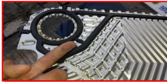
Gambar 4. 11 Posisi packing /perapat yang salah (Sumber : Dokumentasi Pribadi)
