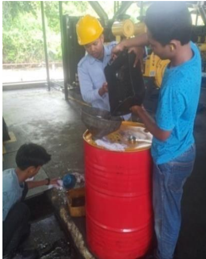
Gambar 2.27 Kegiatan membersihkan saluran oli (Sumber: PT. Megapower Makmur Tbk, 2022)
