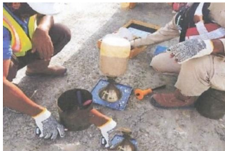
Gambar 4.16 Dokumentasi Perletakan Botol Sandcone Di Daerah Yang Akan Di Uji
