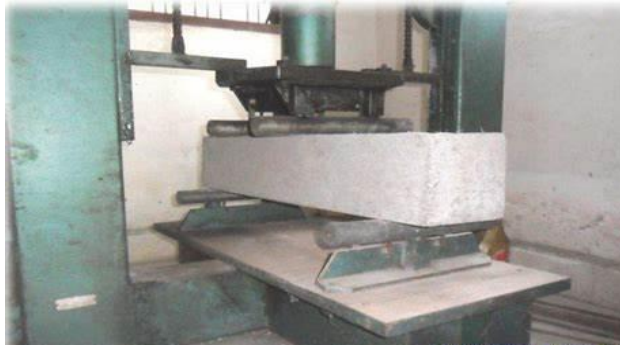
Gambar 3.16 Pengujian Kuat Lentur
