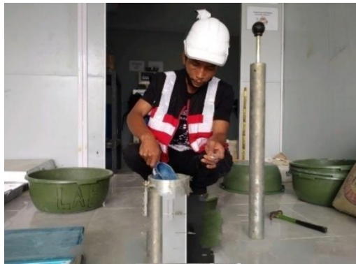
Gambar 4.12 Pemasukan Material Pada Alat Proctor
