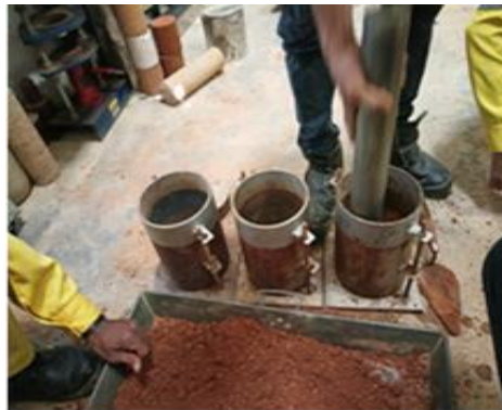
Gambar 3.6 Pengujian Capping Layer
