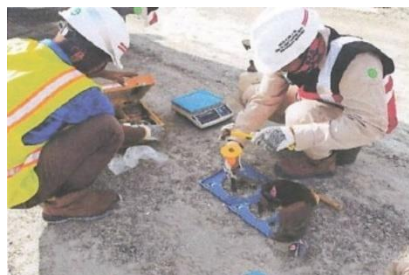
Gambar 4.15 Dokumentasi Penggalian Lubang Uji Sandcone
