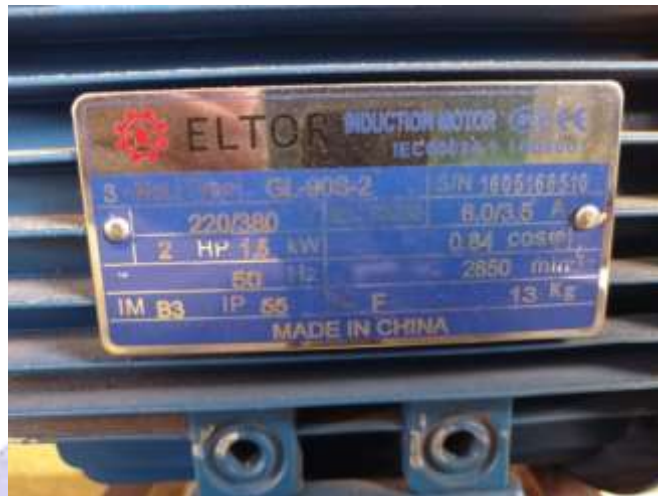
Gambar 3. 5. Spesifikasi Motor Mesin Cutting Sumber: Dokumentasi PT. Cassia Co-op
