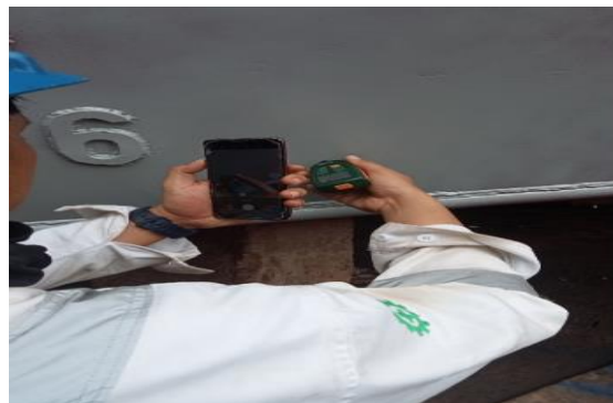
Gambar 2.32 Pengecekan Ketebalan Cat
