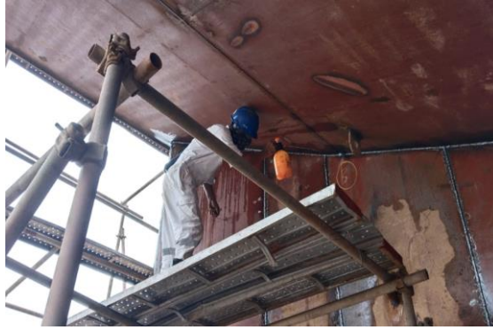
Gambar 2.75 Air Test Di Area Skeg
