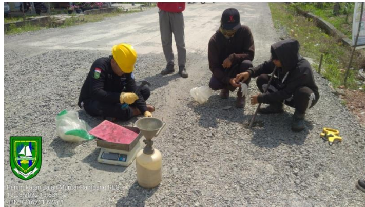
gambar 3.20 pengujian sand cone pada lapisan base A
