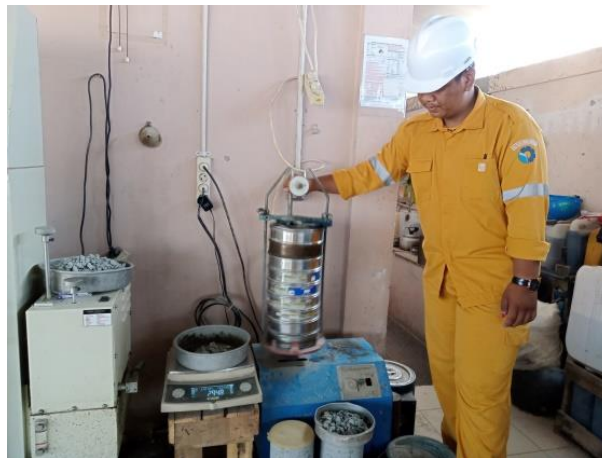
Gambar 3.8 Pengujian analisa saringan Sumber: Dokumentasi KP, Tahun 2022
