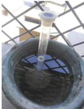
Gambar 3.10 Pengujian spesifik gravity Sumber: Dokumentasi KP, Tahun 2022
