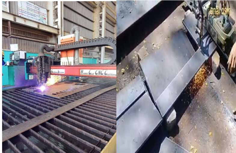
Gambar 3.5. Cutting dengan mesin CNC dan hasilnya
