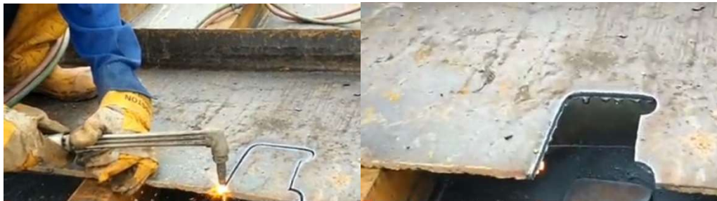
Gambar 3.4. Cutting manual dan hasil yang diperoleh
