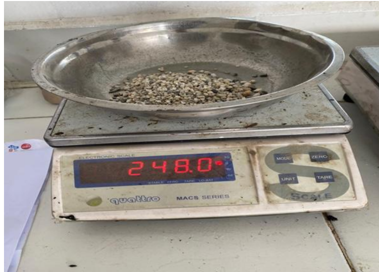
Gambar 3.15 Pekerjaan Gradasi Agregat
