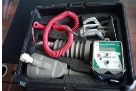
Gambar 2.43. Voltstik (Sumber: PT. Adra Gemilang)
