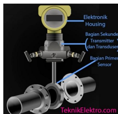
Gambar 3. 13 bagian utama pressure transmitter
