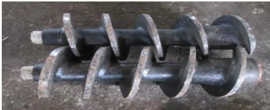
Gambar 4. 10 Kerusakan pada press
