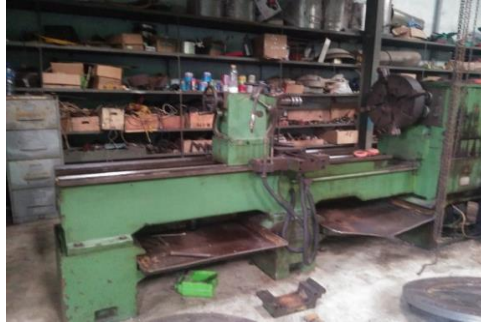
Gambar 3. 16 mesin bubut (Sumber:dokumentasi pribadi)
