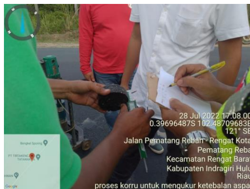
Gambar 3.12 Pengukuran Sampel Laston Lapis Aus (AC-WC NR ) (Sumber: Dokumentasi Lapangan Kerja Praktek 2022)
