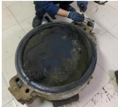
Gambar 4. 13 Buka baut 1 Sumber : Data Olahan 2022
