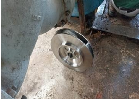
Gambar 4.4 Melepaskan mur dari Impeller
