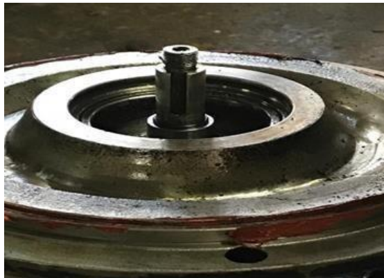
Gambar 4.5 Melepaskan casing impeller
