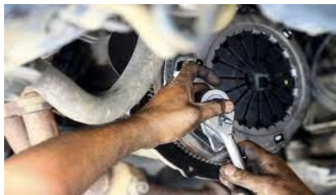
Gambar 4.5.2 Pemasangan unit kopling
