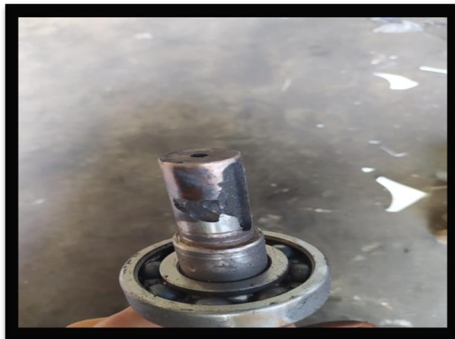
Gambar 4.7 Shaft Mengalami Korosi dan Pecah
