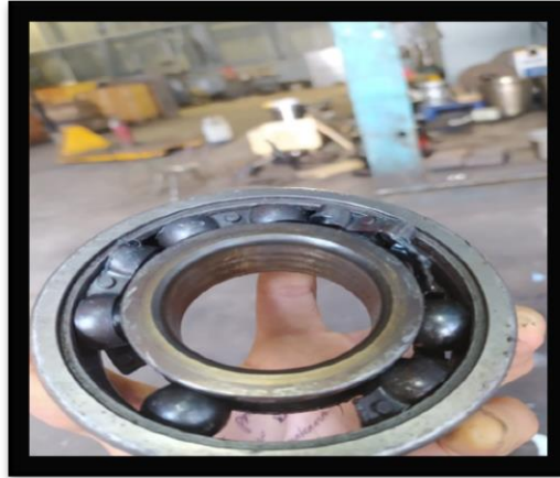
Gambar 4.8 Bearing Terjadi Korosi dan Pecah
