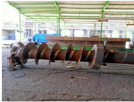
Gambar 4. 22 Pemasangan Daun Screw
