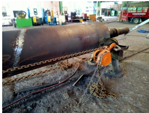
Gambar 4. 20 Pemasangan Daun Screw
