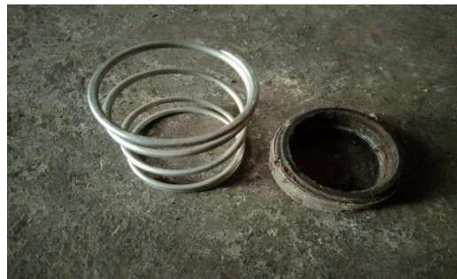
Gambar 4. 6 Kerusakan Pada Maxseal Pompa
