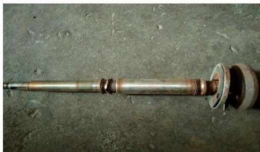
Gambar 4.5 Kerusakan Poros Pada Pompa kondensat
