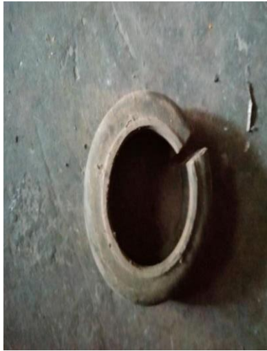
Gambar 4.7 Kerusakan Pada Rubber Coupling Pompa
