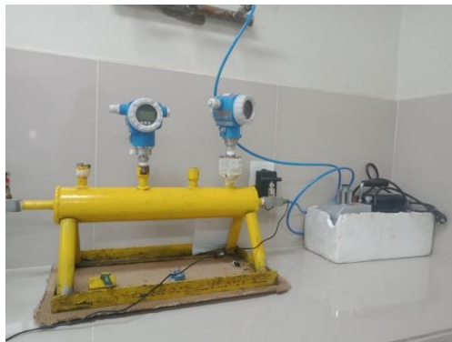
Gambar 2.5 : Verifikasi Pressure Transmitter Menggunakan Alat Vacum. (Sumber Dokumentasi penulis 2022)
