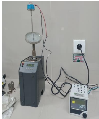
Gambar 2.2 : Verifikasi Temperatur Gauge. (Sumber Dokumentasi penulis 2022)
