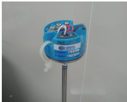
Gambar 2.3.4 Temperatur Transmitter. (Sumber Dokumentasi penulis 2022)
