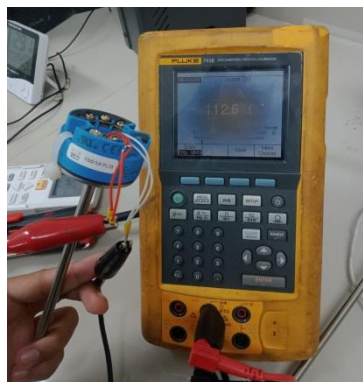
Gambar 3.6 Cek Resistansi Pada Temperatur Transmitter. (Sumber Dokumentasi penulis 2022)
