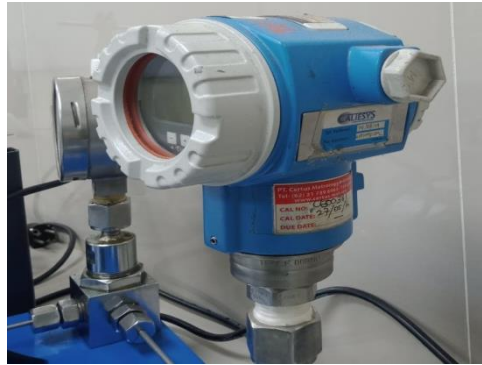
Gambar 2.3.1 : Pressure Transmitter (Sumber Dokumentasi penulis 2022)
