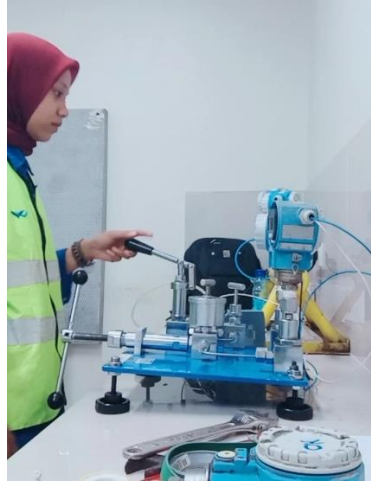
Gambar 2.4 Verifikasi Pressure Gauge Menggunakan Inject Pump. (Sumber Dokumentasi penulis 2022)
