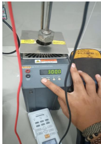
Gambar 3.8 Setting Suhu Dry Block Callibrator (Sumber Dokumentasi penulis 2022)
