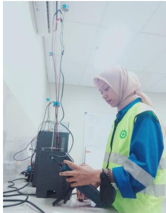
Gambar 2.1 : Verifikasi Temperatur Transmitter. (Sumber Dokumentasi penulis 2022)
