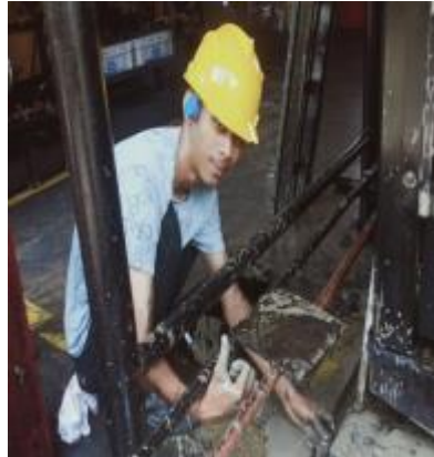
Gambar 2.18 Kegiatan membersihkan saluran oli (Sumber: PT. Megapower Makmur Tbk. 2022)
