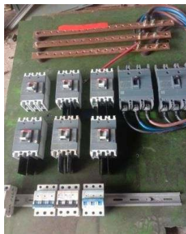
Gambar 2. 14: Merangkai Control Panel . (Sumber: Dokumentasi,2022)
