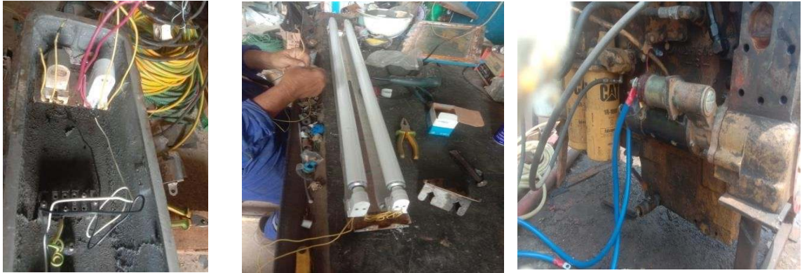
Gambar 2. 4: Perbaikan dan merakit lampu Fluorencen dan Memindahkan Motor Starter dari mesin Rig. (Sumber: Dokumentasi,2022)
