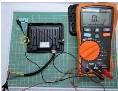
Gambar 3.18: mengukur kontinuitas jalur setiap kabel ke bodi lampu sorot. (Sumber :s-gala.com)
