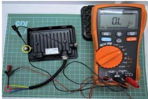
Gambar 3.16: Mengukur Kontinuitas Jalur kabel Ke Bodi Lampu Sorot. (Sumber :s-gala.com)
