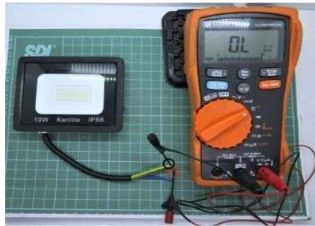
Gambar 3.19: Mengukur Kontinuitas Setiap Kabel. (Sumber :s-gala.com)
