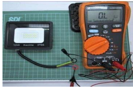
Gambar 3.21: Mengukur Kontinuitas Setiap Kabel. (Sumber :s-gala.com)
