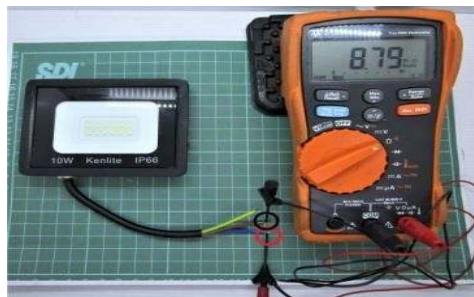
Gambar 3.20: Mengukur Kontinuitas Setiap Kabel. (Sumber :s-gala.com)
