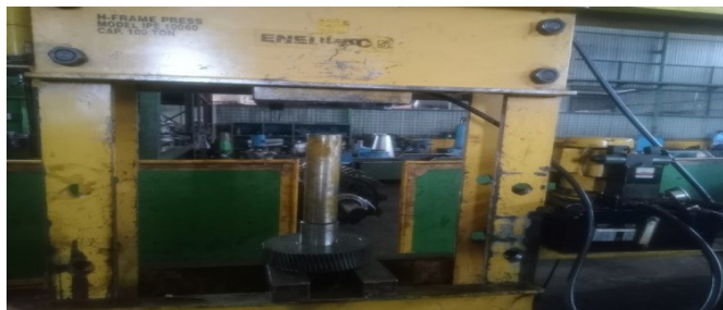
Gambar 4.8 Hidrolik Pembuka Bearing Sumber: PT. Indah Kiat Pulp&Paper
